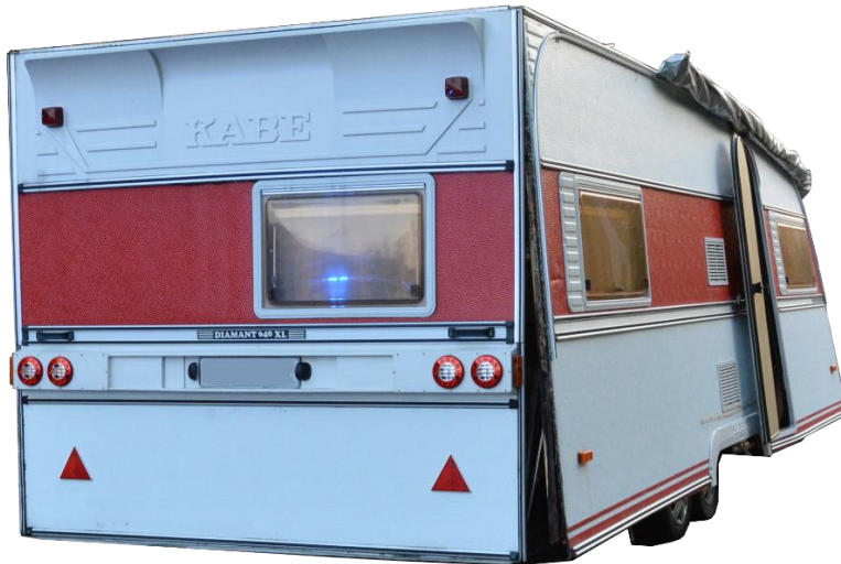
Figur 14: Campingvognen sett bakfra på høyre side, hvor hele sideveggen har løsnet. Foto: Statens vegvesen
