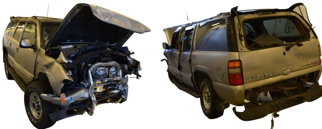
Figur 12: Utvendig deformasjon av kombinertbil. Foto: SHT
