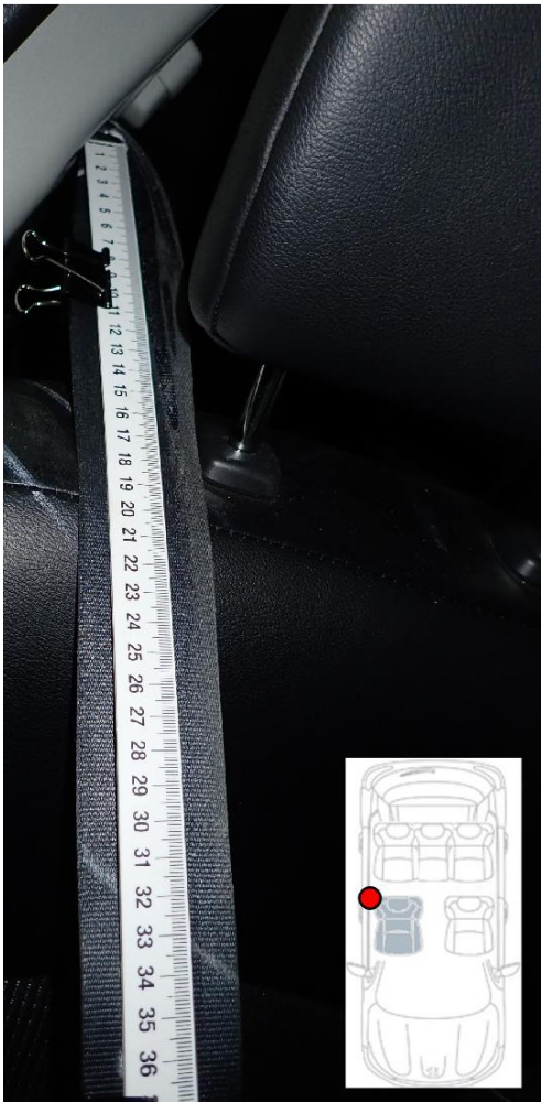
Figur 8: Bilbeltet i passasjeretsetet foran. Friksjonsmerker ved B-stolpen, og over øvre del av seterygg, samt ved hoftefestet. Foto/illustrasjon: SHT
