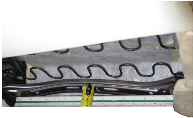
Figur 7: Tverbøyle på nedre del av seteryggen var deformert. Foto: SHT
