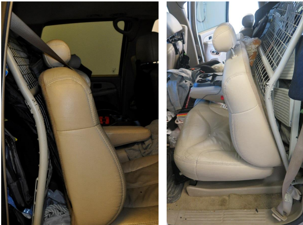
Figur 13: Deformasjon av beskyttelsesvegg på hhv. høyre og venstre side. Foto: Statens vegvesen og SHT
