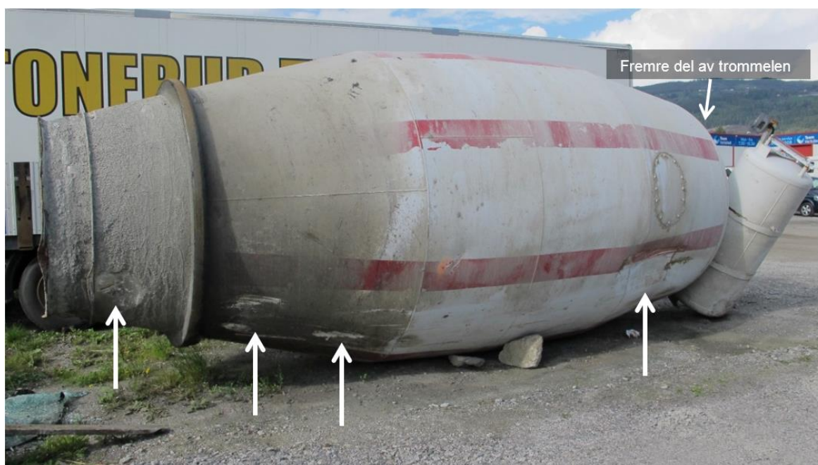
Figur 4: Pilene markerer skader betongbilens trommel fikk i velten. Foto og illustrasjon: SHT
