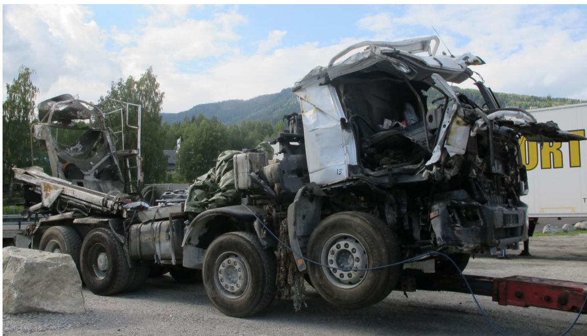
Figur 3: Betongbilen ble påført skader på høyre side og i front. Foto: SHT
