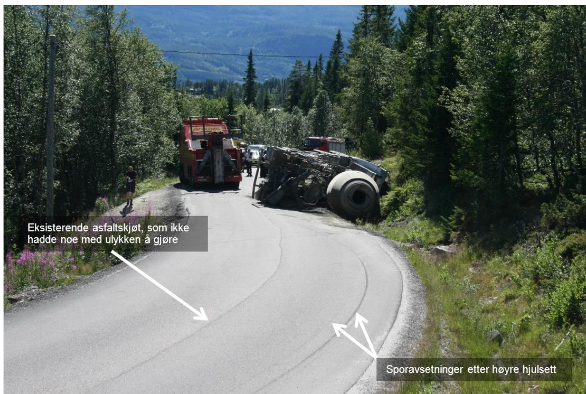
Figur 6: Sporavsetninger etter betongbilens høyre hjulsett. Foto: Statens vegvesen. Illustrasjon: SHT
