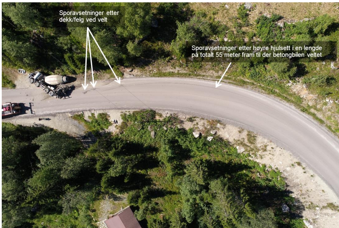
Figur 5: Avsatte spor etter ulykken. Foto: Statens vegvesen. Illustrasjon: SHT
