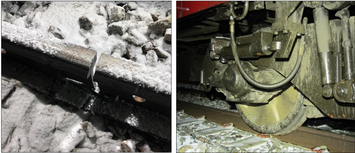
Figur 9: Skinnebrudd og avsporet hjul. Foto: SHT
