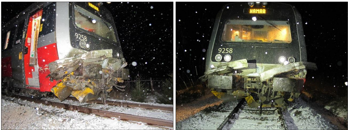
Figur 3: Skader i fronten på toget. Foto: SHT
