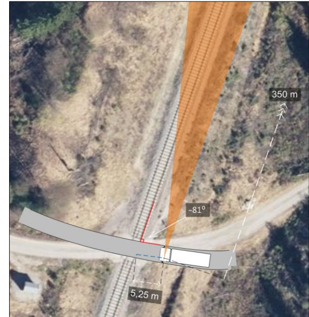
Figur 32: Vinkelen som trengs mellom kjøreveien og jernbanelinjen for at siktlengden ved sittende fremoverlent posisjon skal være ca. 350 m er ca. 81^\circ . Foto: © Kartverket. Illustrasjon: SHT
