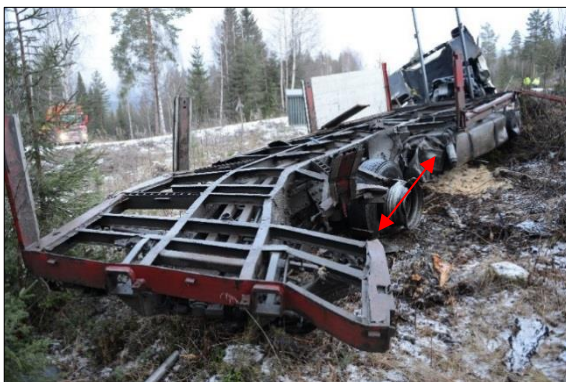
Figur 7: Skader på lastebilen. Toget traff i området som rød pil viser. Foto: SHT
