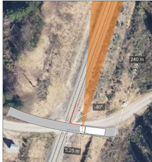
Figur 31: Vinkelen som trengs mellom kjøreveien og jernbanelinjen for at siktlengden ved sittende fremoverlent posisjon skal være ca. 240 m er ca. 80^\circ . Foto: © Kartverket. Illustrasjon: SHT
