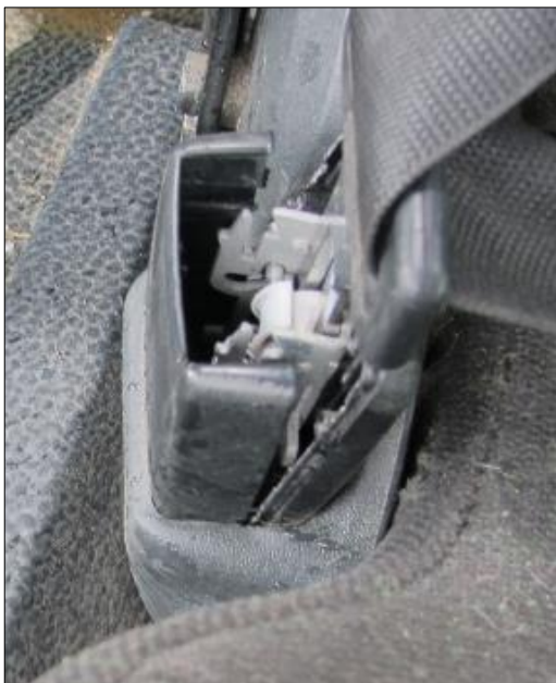
Figur 14: Skadene på låsen til sikkerhetsbelte på førerplassen. Foto: SHT
