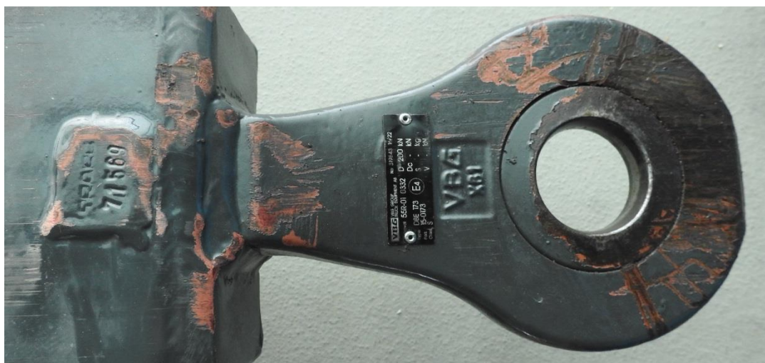
Figur 9: Enden av tilhengerdraget med identifikasjonsnummer fra tilhengerdragfabrikanten TRAKO, og identifikasjonsplate fra produsent av trekkøyet VBG. Foto: SHT
