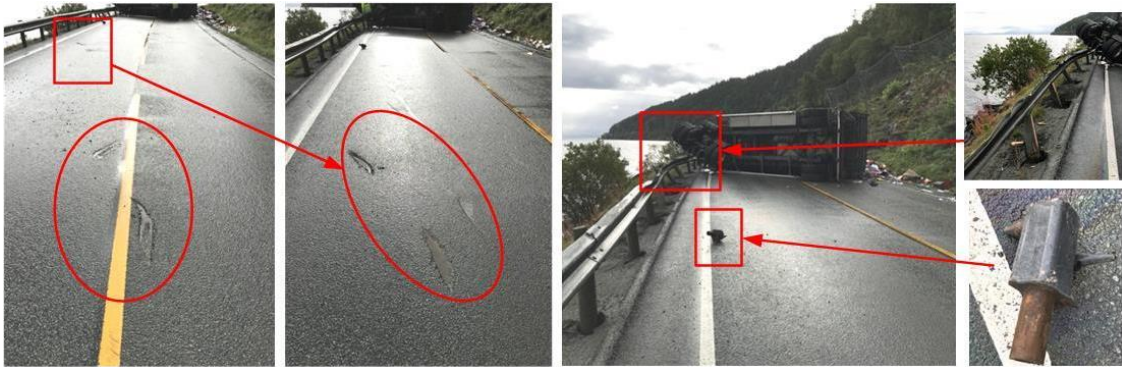
Figur 4: Skrapemerker i veibanen, deler fra tilhengeren og deformert siderekkeverk i venstre kjørefelt. Foto: Politiet
