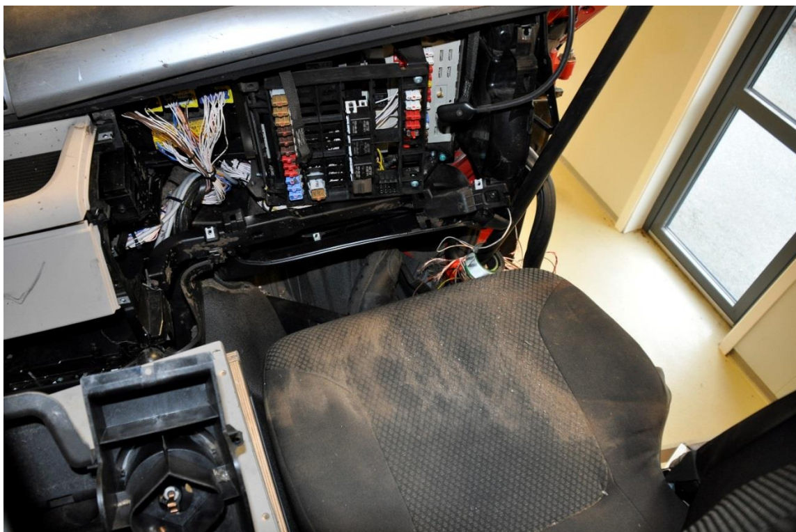
Figur 4: Det var overlevelsesrom i passasjerstet foran etter ulykken. Foto: SHT
