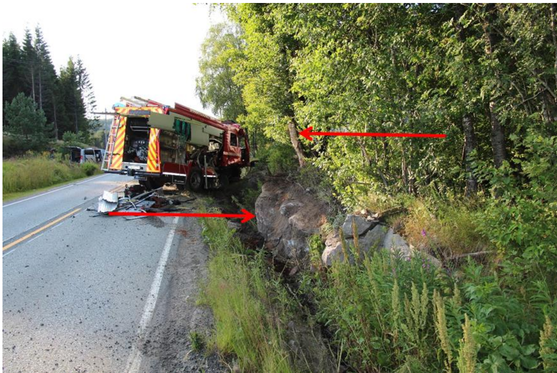
Figur 8: Bergnabben og treet som brannbilen traff med høyre front og side, før den stoppet i en stikkrenne ca. 12 meter lenger framme. Foto: Statens vegvesen. Illustrasjon: SHT
