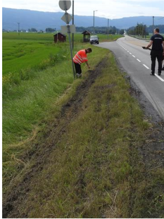
Figur 4: Sporavsetning fra begge hjulsett. Foto: SHK
