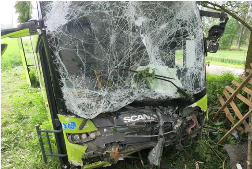
Figur 5: Bussens skader i front. Foto: SHK
