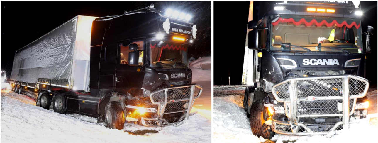
Figur 10: Deformasjoner på trekkvognens høyre kant. Foto: Politiet
