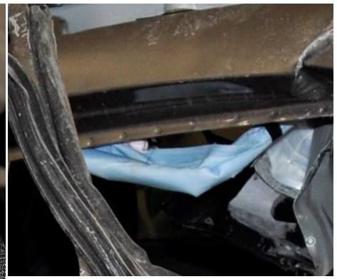
Figur 9: Vinduskollisjonsputen på førerside, der svart forsegling var intakt. Foto: SHK
