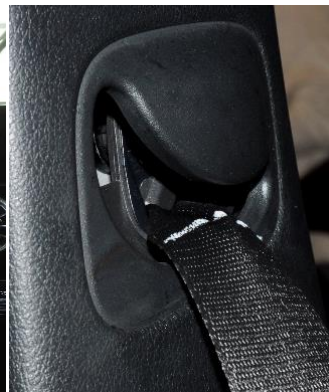
Figur 8: Fastkilt bilbelte ved høyre framsete. Foto: SHK
