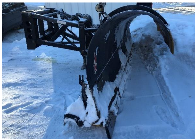
Figur 27: Frontskjær med høvel av typen «Nordic Combi Double». Foto: SHK
