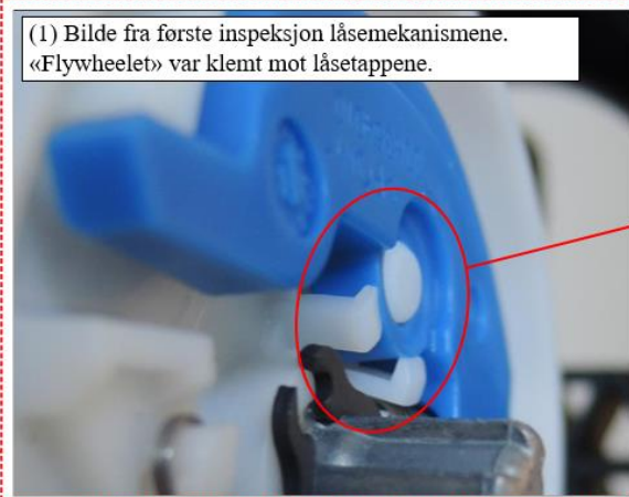
Figur 35: Prinsipp, plassering og undersøkelse av retractorhusene i framsetene. Undersøkelse av «flywhelet» vises innenfor rød stiplet linje. Illustrasjon: SHK Statens havarikommisjon
