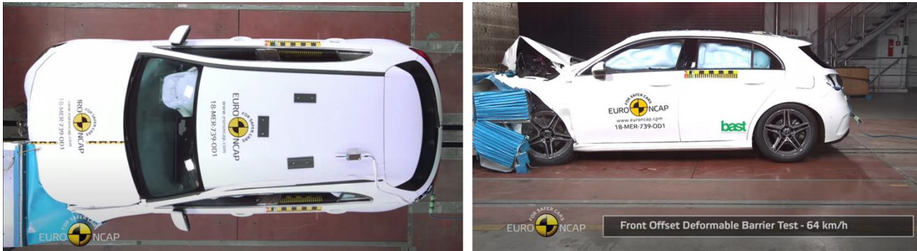
Figur 20: Skjermtklipp fra frontkollisjon med 40 % overlapp i 64 km/t, der vinduskollisjonsputene løser ut. Video: Euro NCAP
