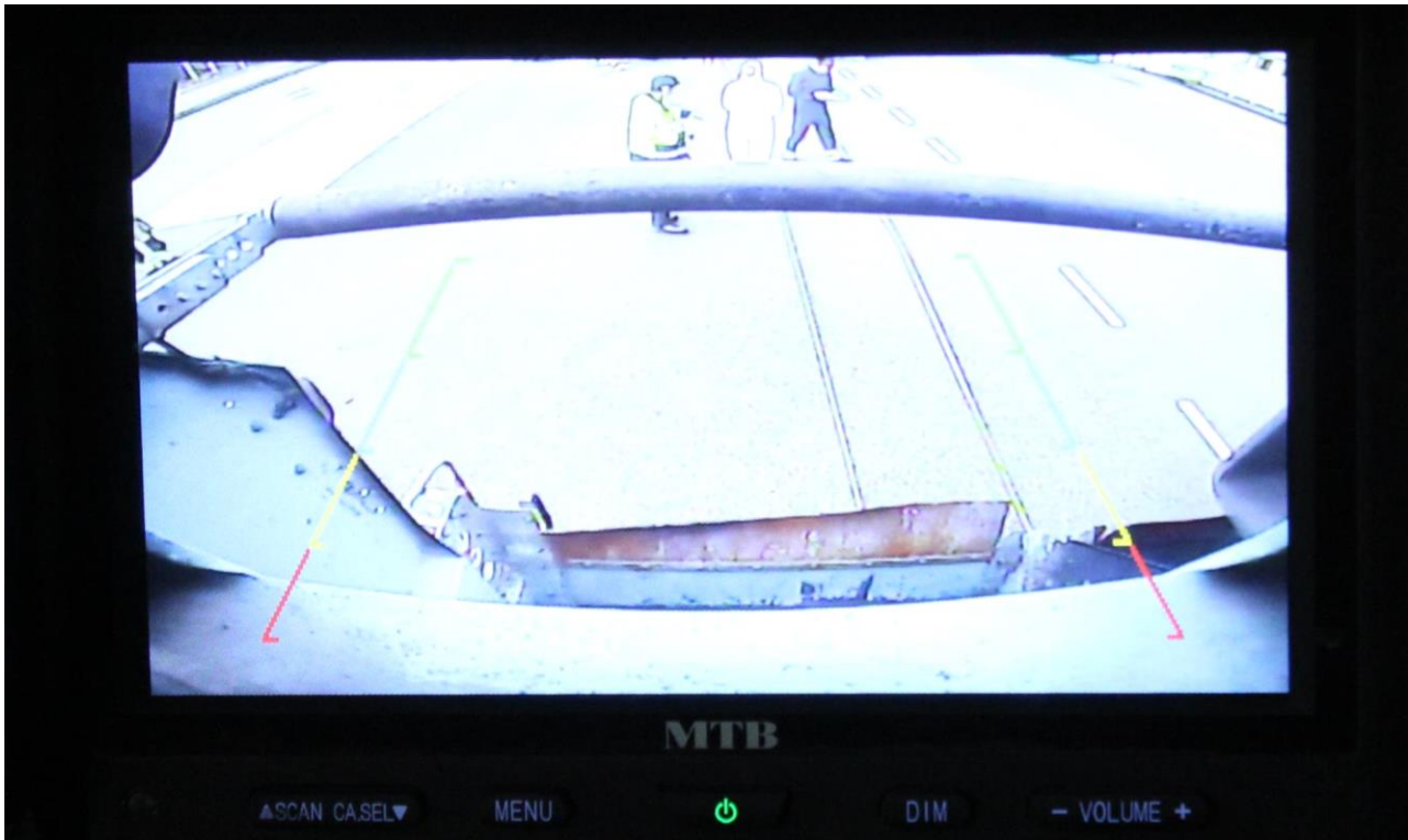
Figur 9: Den 170 cm høye markøren (med hvit overtrekksdress) var synlig i full høyde inntil ca. 5,8 meter fra renovasjonsbilens bakre ende. Foto: SHK
