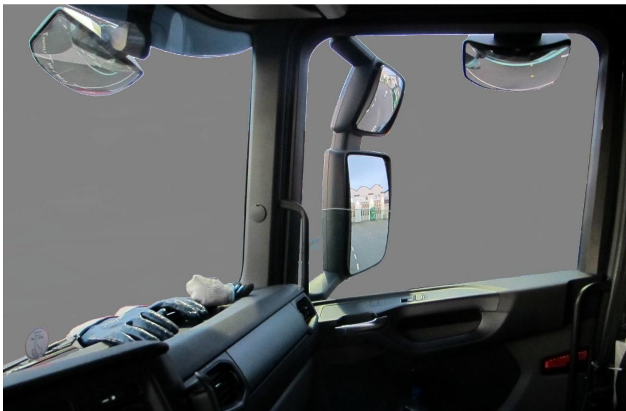
Figur 4: Vidvinkelspeil foran bil og ved høyre dør, samt sidespeil med vidvinkelspeil. Foto og redigering: SHK
