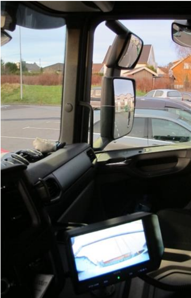
Figur 6: Kameraskjermens plassering i førerhytta. Foto: SHK
