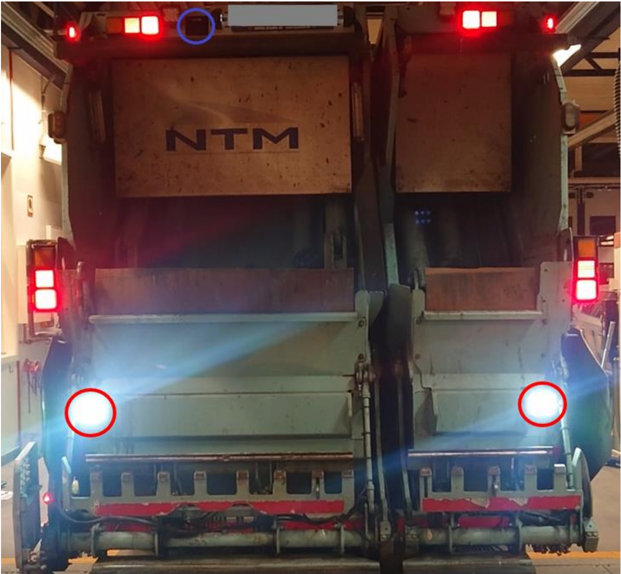
Figur 5: Arbeidslys bak som slås på ved rygging, markert med røde sirkler. Linse til ryggekamera er markert med blå sirkel, øverst i bildet. Foto: SHK
