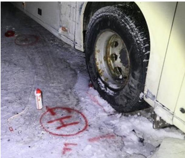
Figur 16: Spor i snøen viser retningsendringen til det venstre framhjulet til enhet B (markert med «H»). Foto: Statens vegvesen
