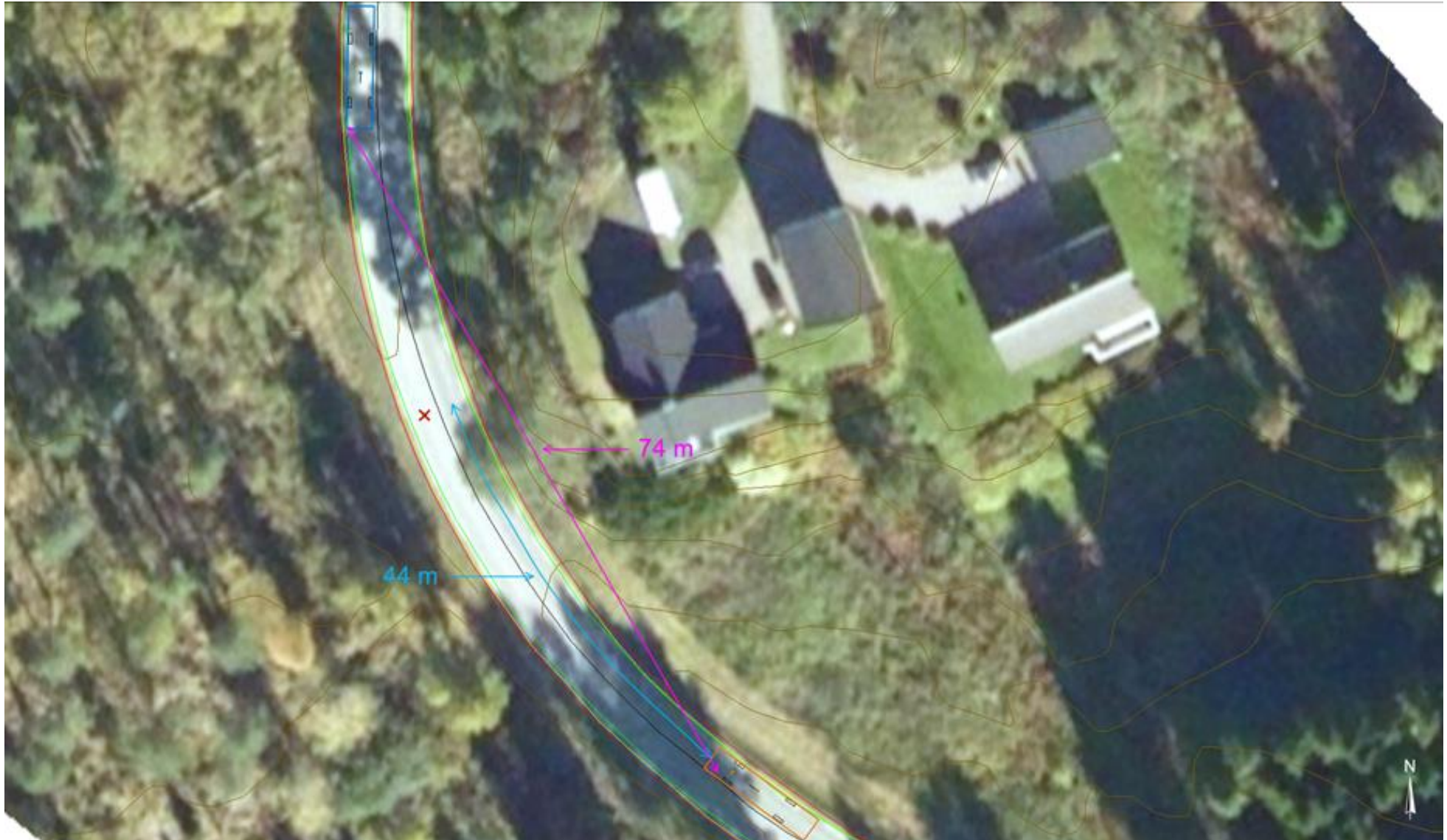
Figur 35: Simulert siktlengde mellom to busser tilsvarende kjøretøyene involvert i ulykken når bussen på vei sørover først er mulig å oppdage for bussen på vei nordover, samt avstanden fra sistnevnte til kollisjonspunktet. Oversiktsbilde: © Kartverket. Geometridata: Norconsult. Illustrasjon: SHK
