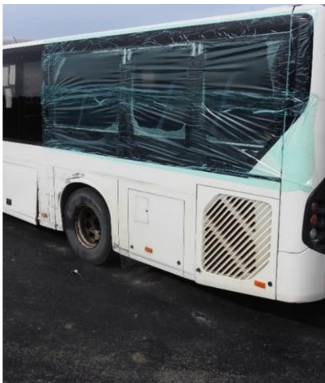
Figur 12: Skader bak på enhet B. Foto: SHK
