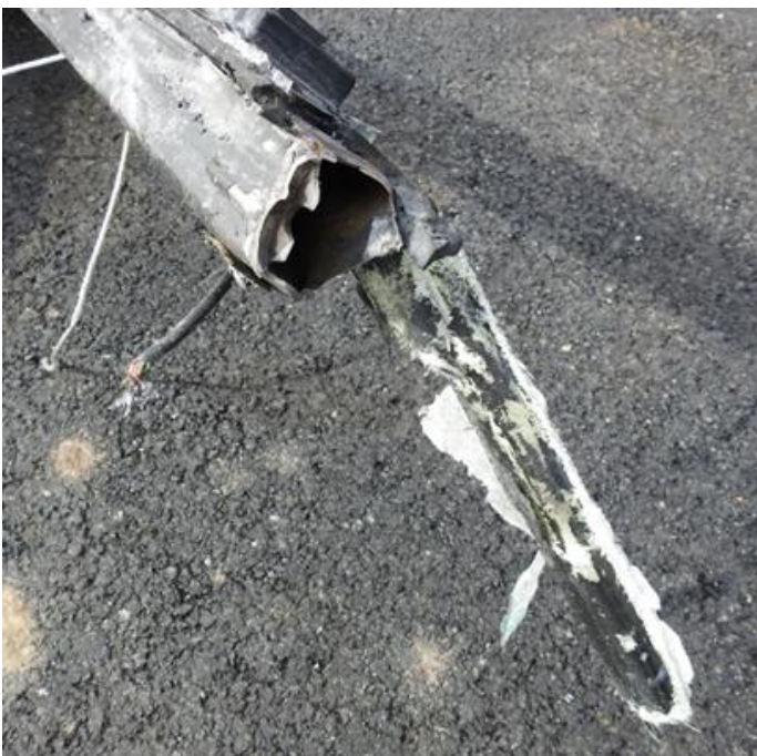
Figur 9: Øvre del av avrevet A-stolpe fra enhet A. Foto: SHK
