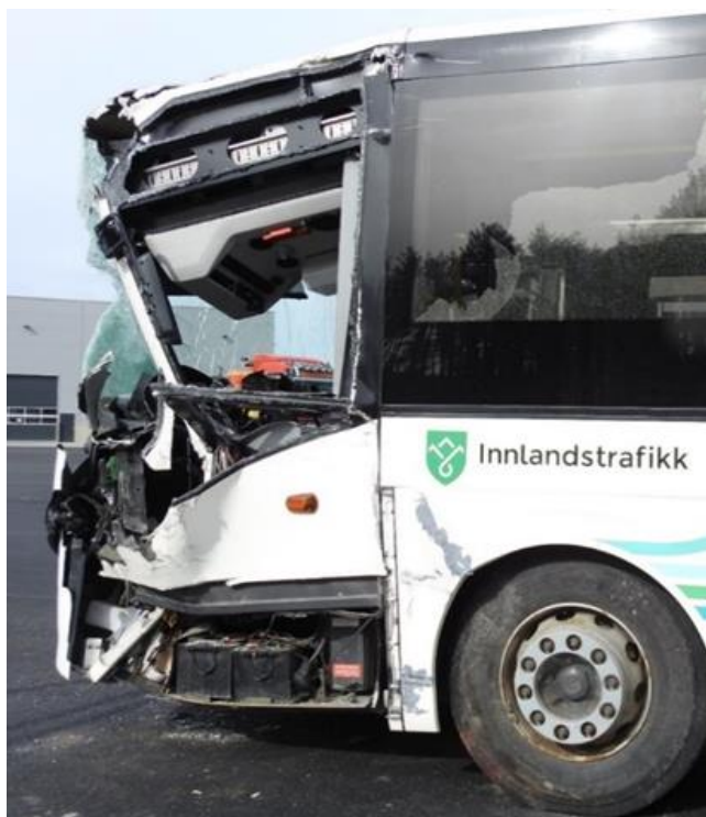
Figur 11: Skader foran på enhet B. Foto: SHK
