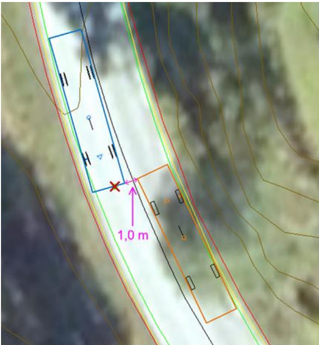
Figur 32: Avstanden mellom to busser tilsvarende de involverte kjøretøyene når hele kjørebanebredden utnyttes ut til veiens kantlinjer og bussenes fronter er ved kollisjonspunktet. Oversiktsbilde: © Kartverket. Geometridata: Norconsult. Illustrasjon: SHK
