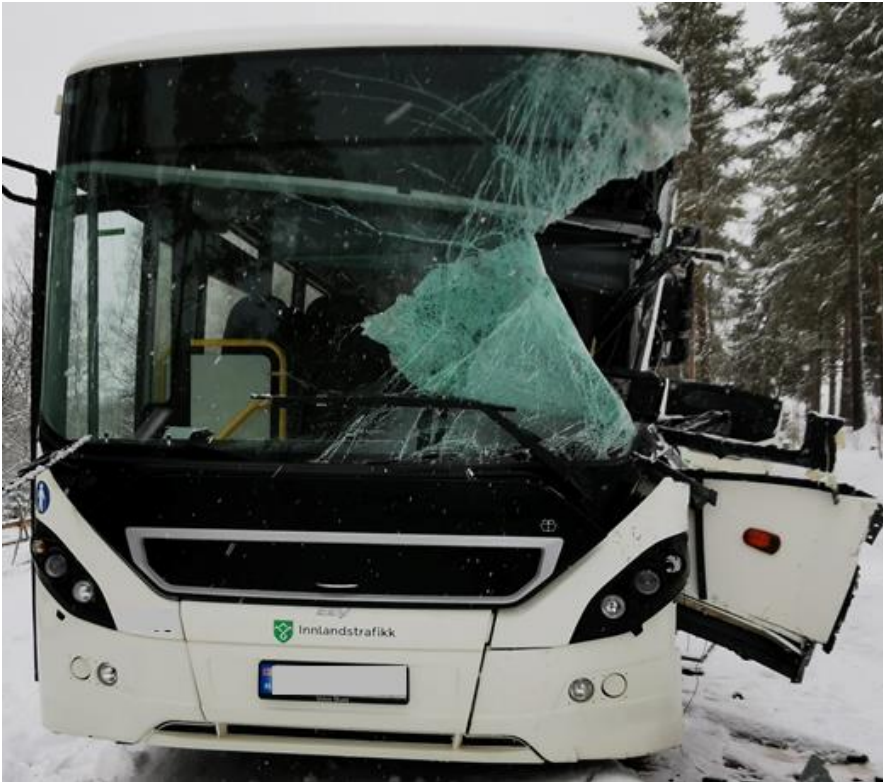
Figur 4: Skader på enhet B. A-stolpen til enhet A har blitt tredd inn i enhet B gjennom frontvinduet på venstre side. Foto: Stange Brannvesen
