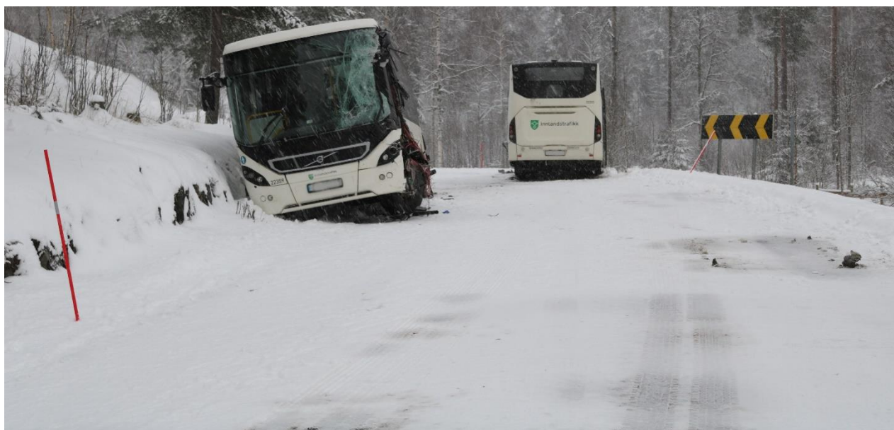
Figur 31: Veibanen var brøytet tilnærmet veibanens bredde, inkludert skulder, i forkant av at ulykken inntraff. Bildet er tatt ca.kl. 1830. Foto: Statens vegvesen
