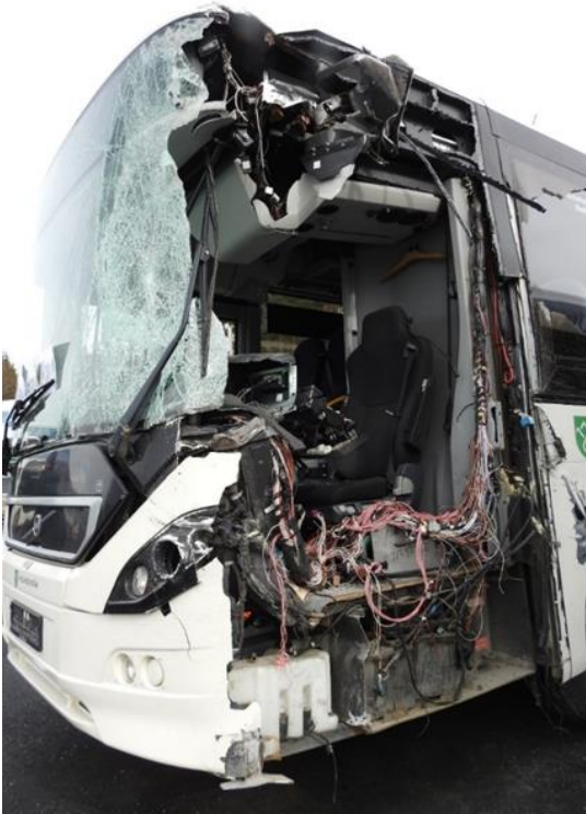
Figur 7: Skader foran på enhet A. Foto: SHK Figur 8: Avrevet A-stolpe på enhet A. Foto: SHK
