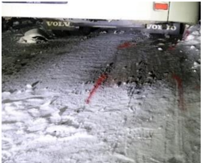
Figur 17: Spor i snøen viser retningsendringen til den bakre akselen til enhet B. Foto: Statens vegvesen
