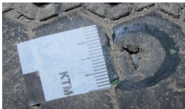
Figur 11: Stein som er presset inn under dekkmønsterets overflate. Foto: SHK
