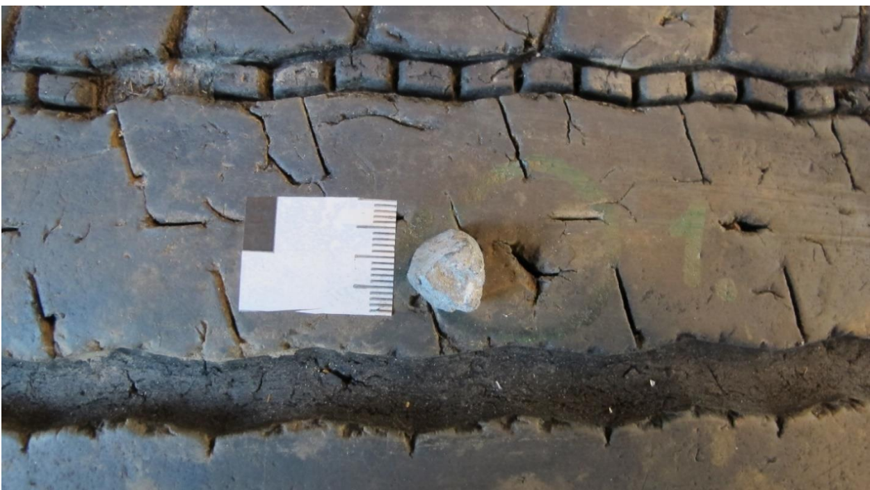
Figur 9: Steinen som var presset helt inn til stålbeltet, se figur 8. Foto: SHK
