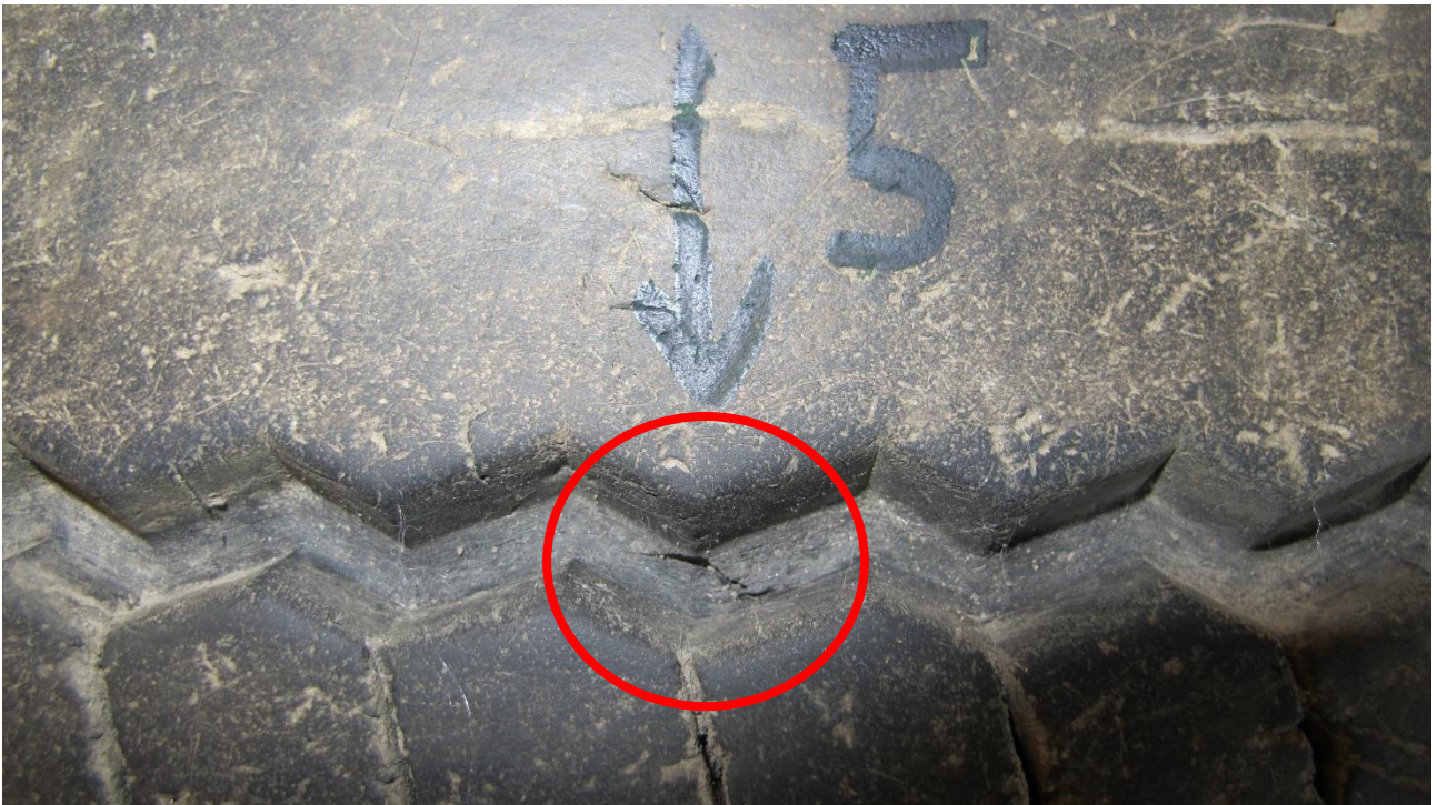
Figur 14: Sprekk mellom dekkskulder og hoveddrille på dekkets innerside som går inn til stålbeltet. Foto SHK
