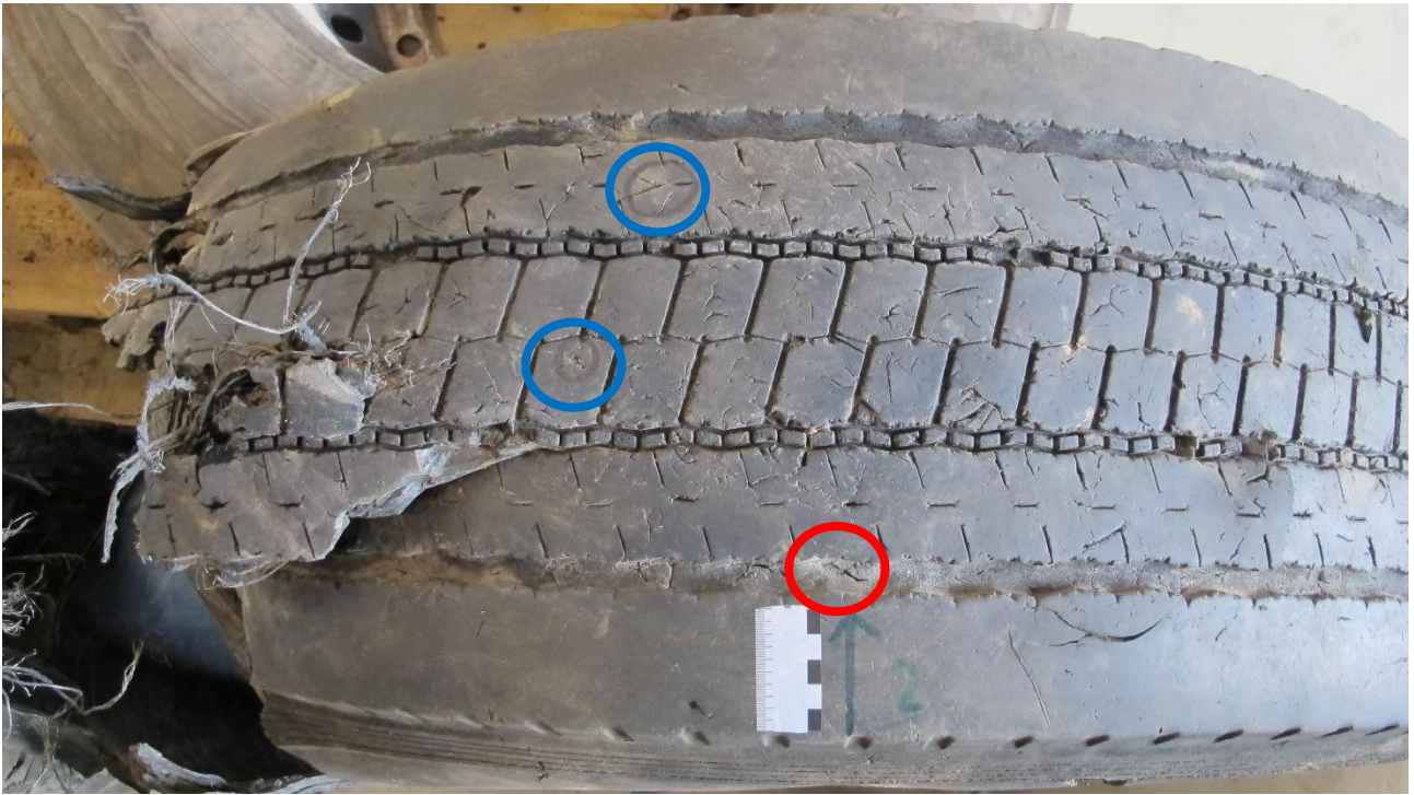
Figur 5: Slitebanen på venstre framdekk, sprekker og skader. Sirkler markerer skader inn til stålbeltet. Foto: SHK
