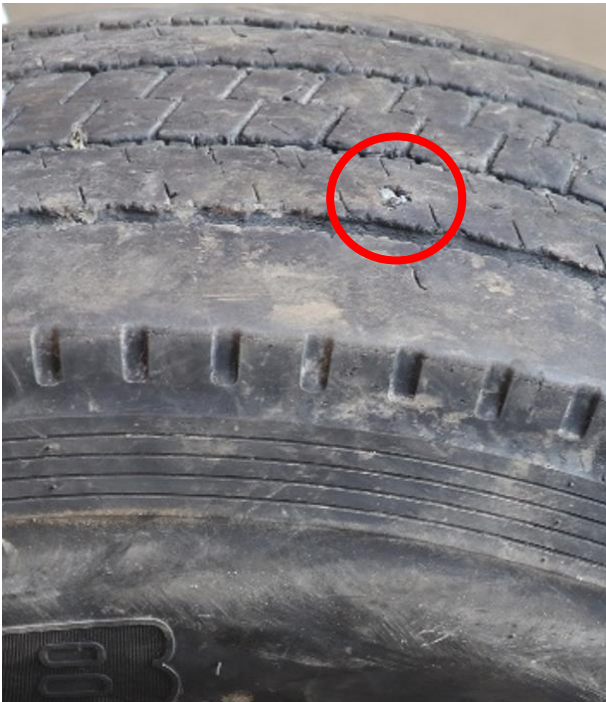
Figur 8: Rød sirkel viser hvor stein har presset seg helt inn til stålbeltet i venstre framdekk. Foto SHK
