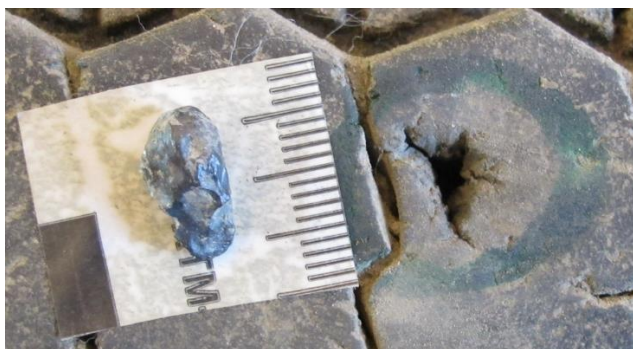
Figur 12: Størrelsen på steinen som var presset inn i dekkets slitebane. Foto: SHK
