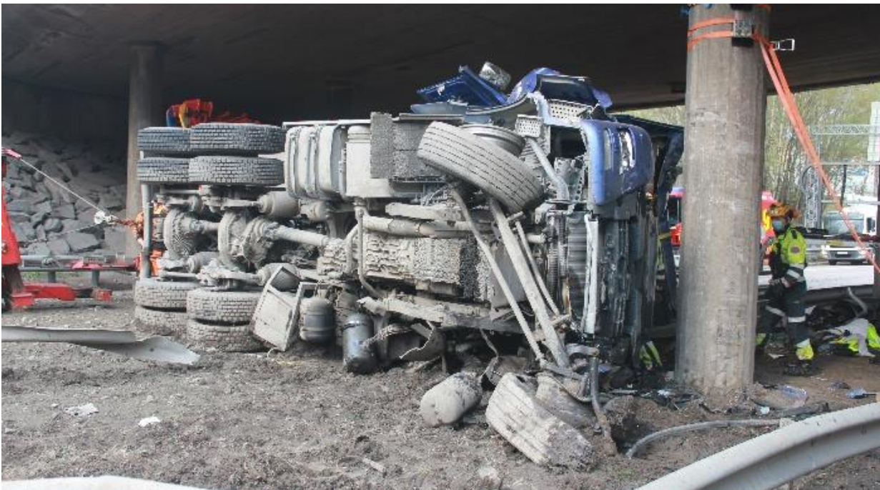
Figur 4: Sluttposisjonen og skadene til lastebilen etter kollisjon med brupilaren som stod i midtdeleren mellom kjøreretningene. Foto: SHK
