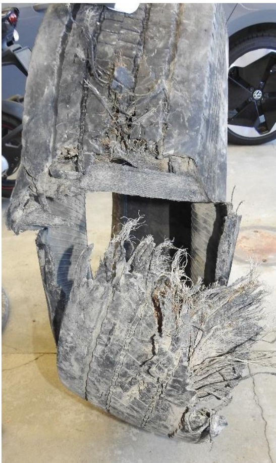
Figur 6: Venstre framdekk hvor bærelaget (stålbeltet) i dekket har delt seg. Foto: SHK
