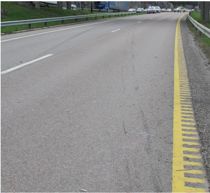
Figur 2: Spor fra venstre framhjul på lastebilen sett i østlig retning, der vogntoget kom fra. Foto: SHK
