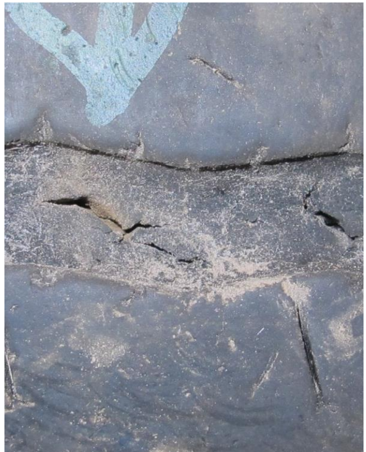
Figur 7: Sprekk inn til stålbeltet, se rød sirkel i figur 5. Foto: SHK
