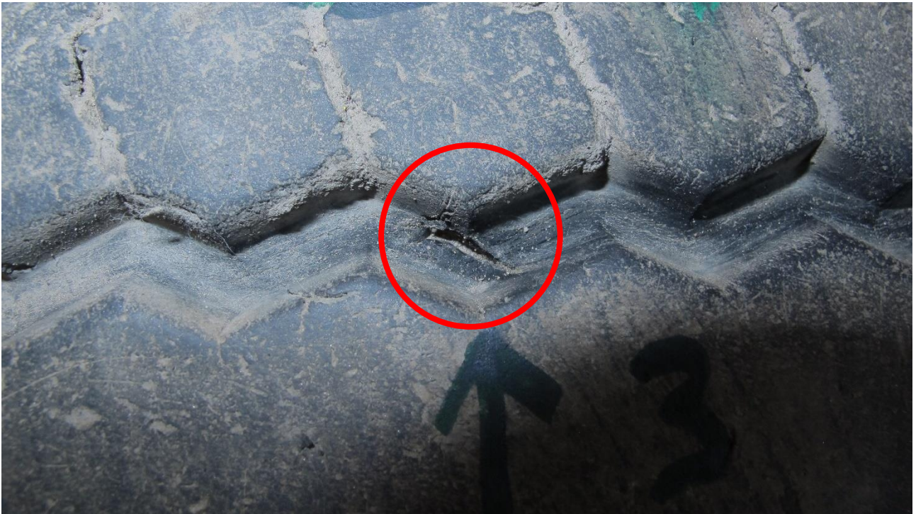
Figur 13: Sprekk mellom dekkskulder og hoveddrille på dekkets ytterside som ikke går inn til stålbeltet. Foto: SHK
