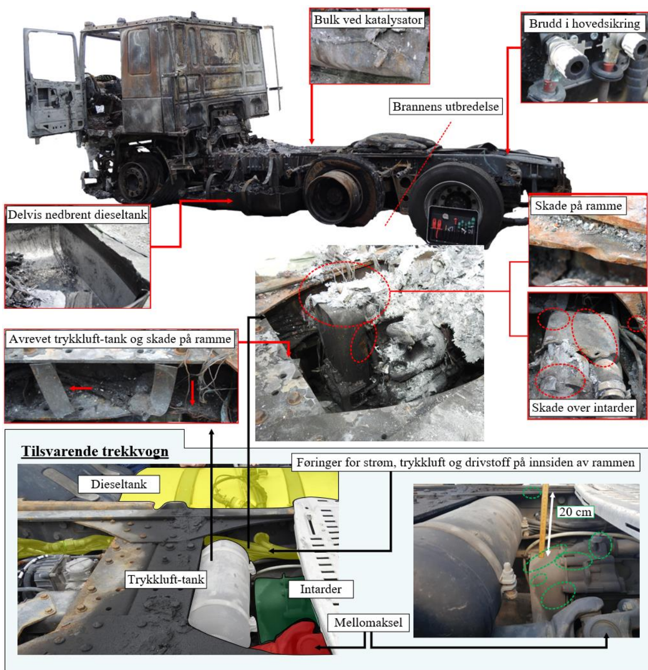
Figur 16: Undersøkelse av den utbrente trekkvognen og tilsvarende modell. Foto: DAF/SHK. Illustrasjon: SHK
