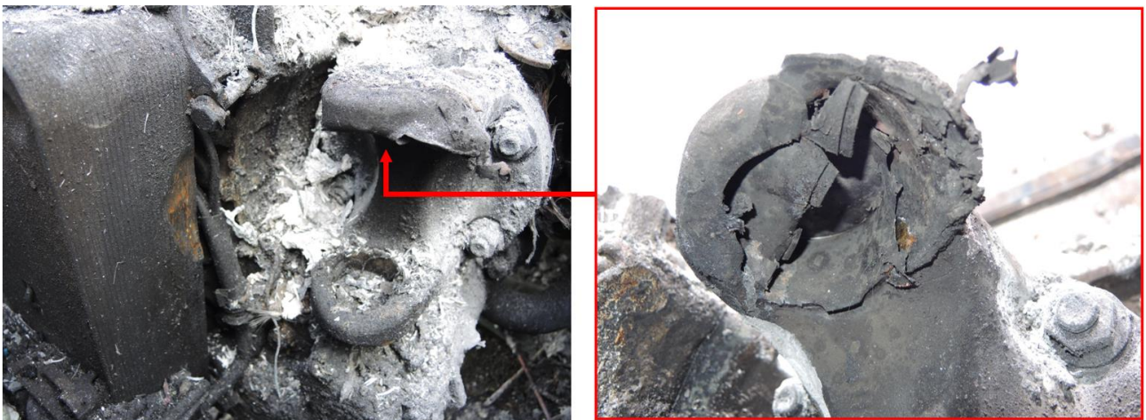
Figur 18: Fremre flens til girkassen, til høyre for intardereren. Nærbildet viser at krysset har vridd seg ut. Foto: SHK
