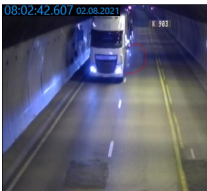
Figur 1: Første tegn til havari, med trykkutblåsing til venstre under trekkvognen (rød strek). Foto: VTS/SHK
