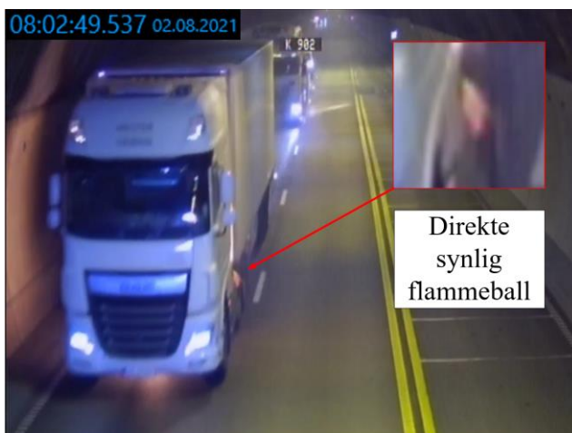
Figur 5: Direkte synlig, kortvarig flammeball på venstre side mellom trekkvogn og tilhenger. Foto: VTS/SHK
