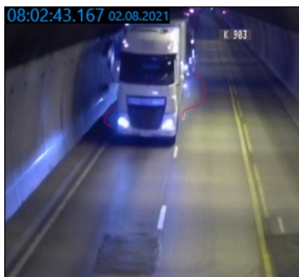
Figur 2: Trykkutblåsing og sky synlig på begge sider under trekkvognen (rød strek). Foto: VTS/SHK
