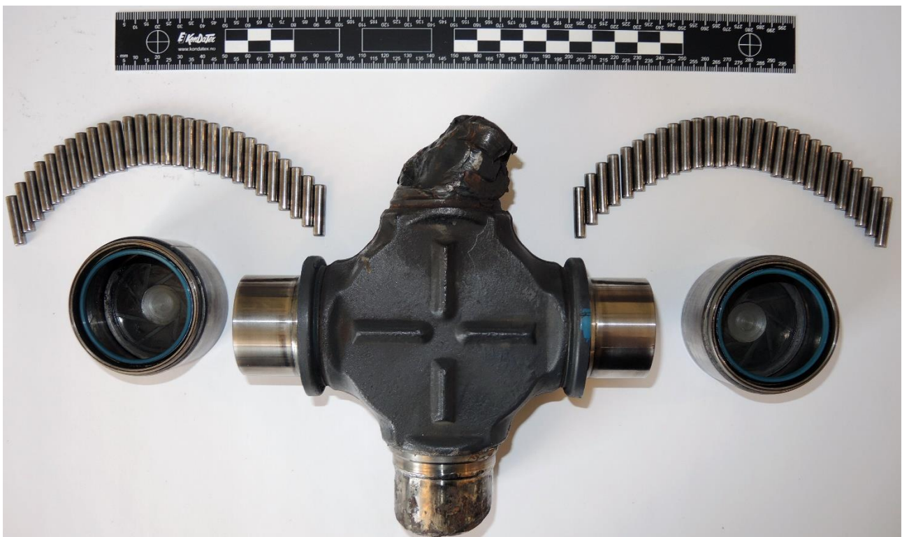
Figur 20: Krysset der de gjenværende lagrene var åpnet. Foto: SHK
