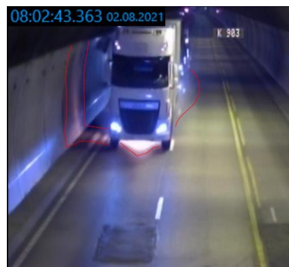
Figur 3: Første antennelse, med refleksjon på vegg mellom trekkvogn og semiltilhenger (rød strek). Foto: VTS/SHK
