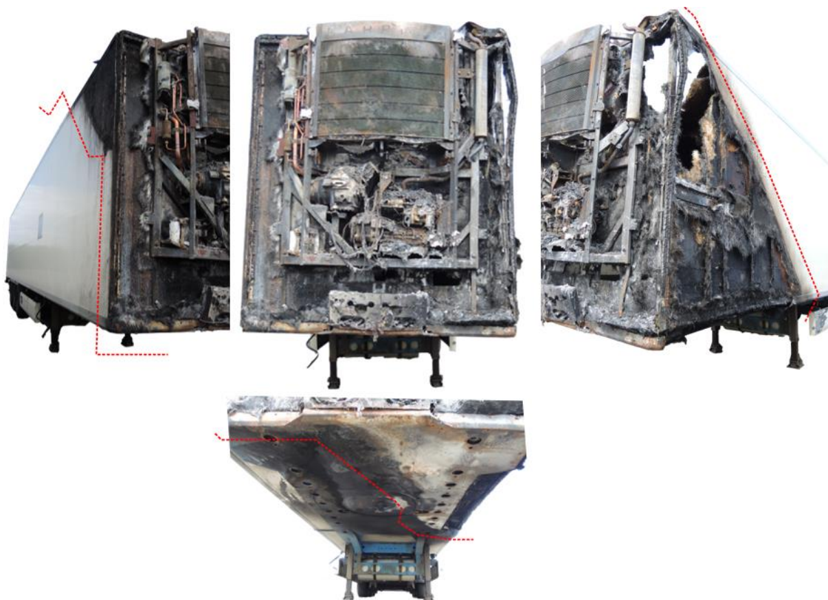
Figur 21: Skader på semitilhengeren. Røde streker markerer vinkel og utbredelse av brannen. Foto/illustrasjon: SHK
