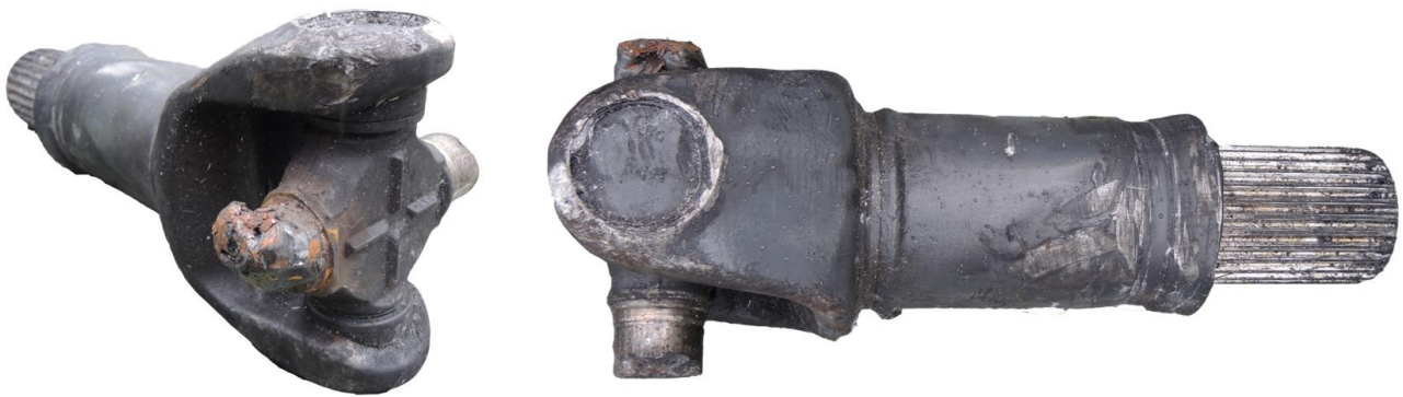
Figur 17: Fremre ledd av mellomakselen med kryss som lå i veibanen bak vogntoget. Krysset var vridd ut av koblingen mot fremre flens til girkassen. Foto: SHK
