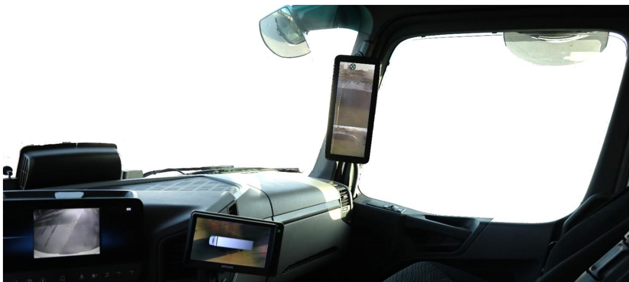
Figur 2: Deler av førermiljøet. Skjermen til venstre viser ryggekamera, skjermen i midten viser 360° kamera, skjermen på a-stolpen viser kammerspeil. Det er to utvendige vidvinkelspeil. Foto: SHK
