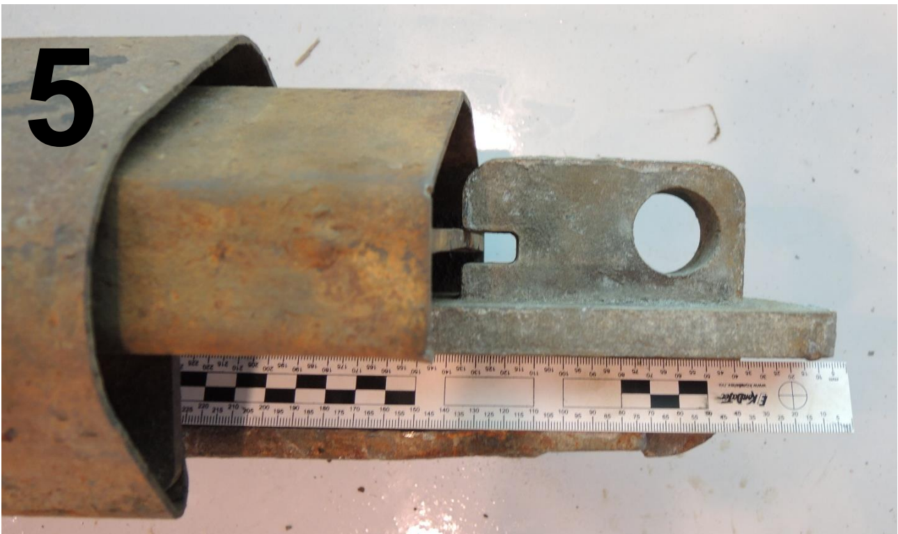
Figur 49: Glideplaten kommer ikke i inngrep med låseklossen når låsehåndtaket er i lukket posisjon og bolten er deformert, samtidig som låseklossens inngrepsdeler er i kontakt med høyre hullromskanter på innsetningeplaten. Det gjør at rekkverksendene får en glippe. Foto: SHK
