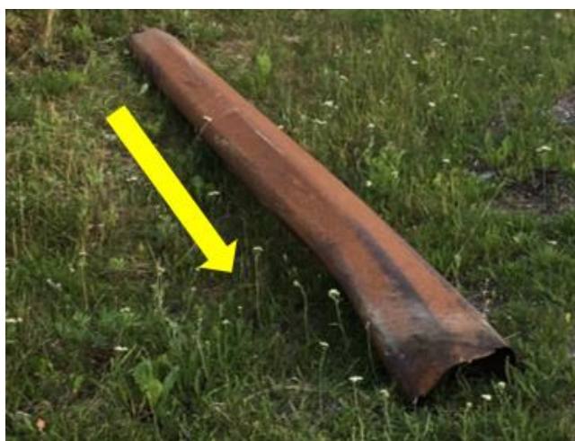
Figur 9: Rekkverksslengden i grøfta hadde synlige skrapemerker. Gul pil viser bilens kjøreretning. Foto: Politiet. Illustrasjon: SHK
