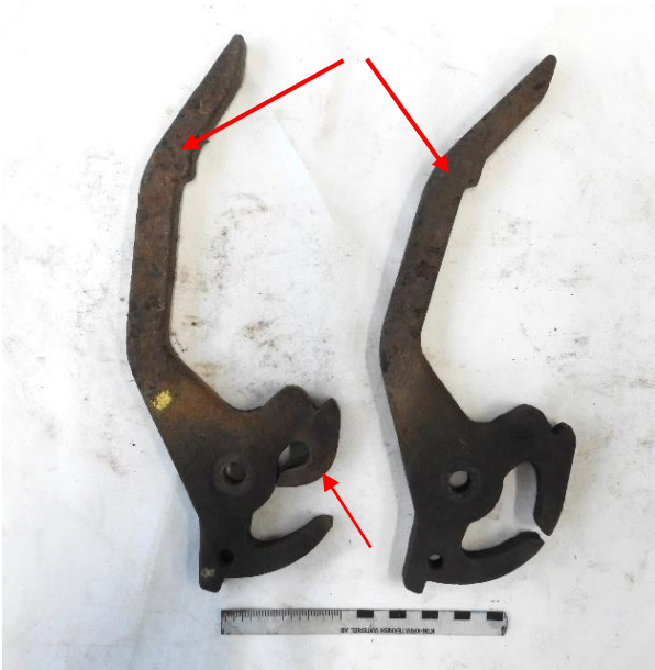
Figur 39: Deformert innvendig del av låshåndtaket på lås nr. 5 til venstre og intakt låsehåndtak til høyre. Utvendig del av låsehåndtaket ble ikke funnet deformert. Foto og illustrasjon: SHK
