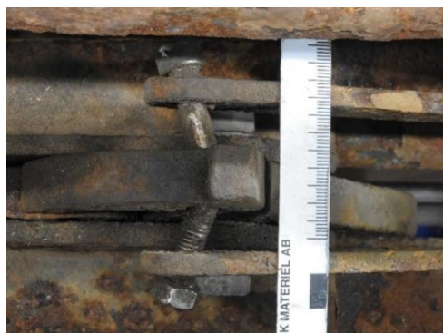
Figur 35: Deformert bolt uten hylser. Lenkearmene ligger ikke parallelt med hverandre. Plassering av bolt vises i figur 33. Foto: SHK
