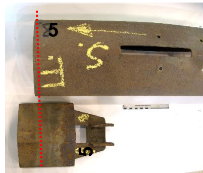
Figur 43: Posisjonen glideplaten ble funnet i, ca. 2 cm over i motsatt rekkverksdel, etter ulykken. Foto og illustrasjon: SHK
