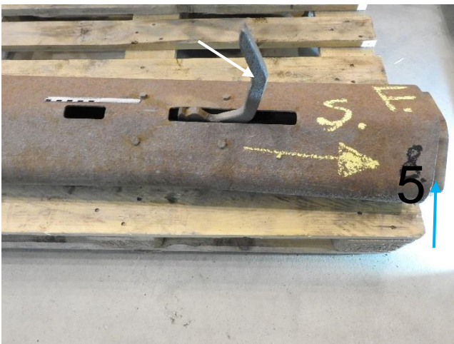
Figur 32: Lås nr. 5. Låsehåndtaket (hvit pil) ble funnet fastlåst i åpen posisjon slik bildet viser. Glideplaten (blå pil) ble funnet nesten helt inne i egen rekkverksende. Foto og illustrasjon: SHK
