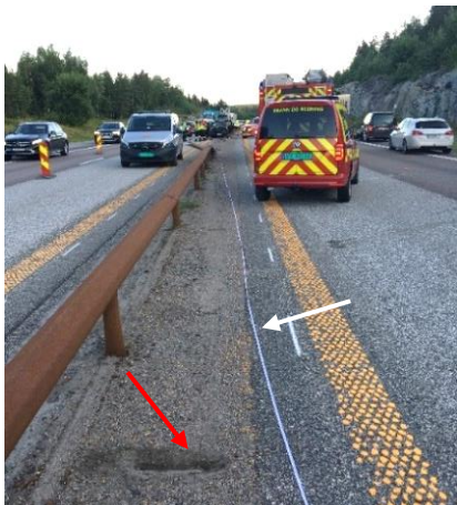
Figur 4: Første sporavsetning i grusen på utsiden av veibanen (rød pil). Målebåndet (hvit pil) viser omtrentlig retning på personbilen før kollisjonen. Foto: Politiet. Illustrasjon: SHK
