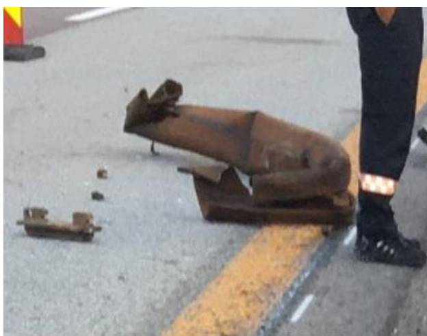
Figur 10: Rekkverksslengden som ble funnet et stykke foran bilens sluttposisjon. Foto: Politiet
