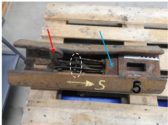
Figur 33: Underside av lås nr. 5, med sikringstappen (rød pil) stående «rett opp» og glideplaten (blå pil) funnet på innsiden av egen rekkverksende. Stiplet sirkel viser plassering av deformert bolt. Foto og illustrasjon: SHK
