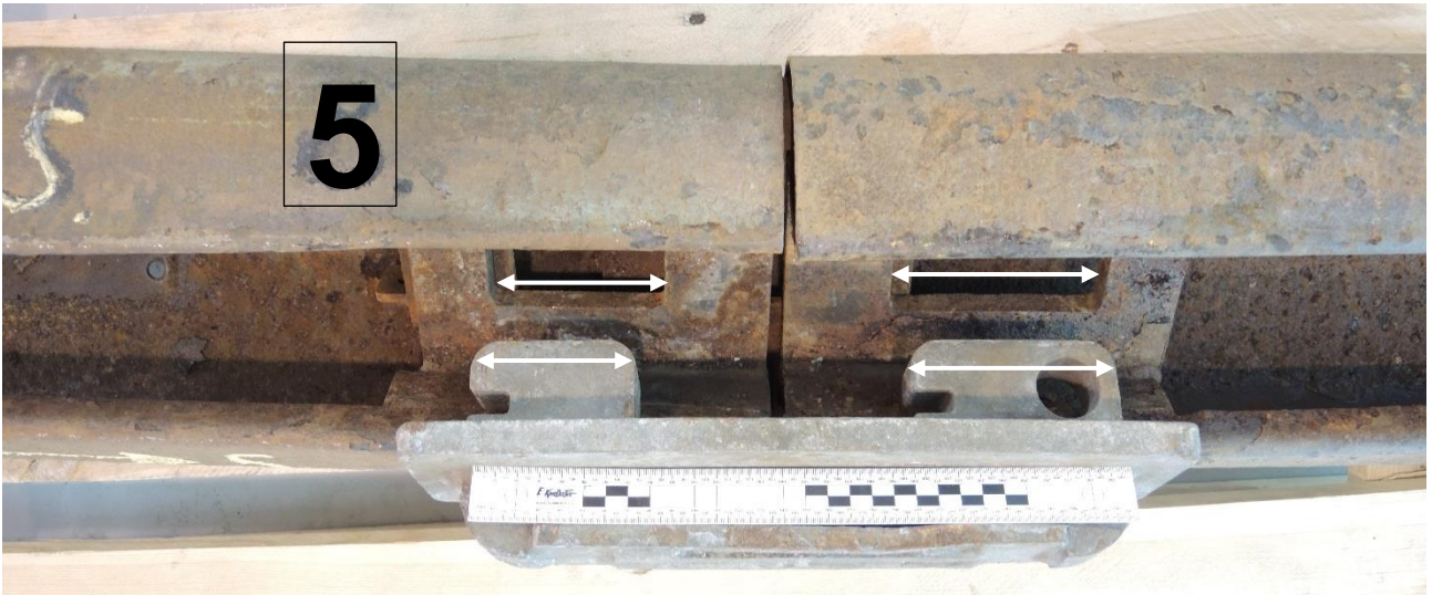
Figur 44: Låseklossens inngrepsdeler og hulrommene på innsetningsplatene er i forskjellige lengder. Foto og illustrasjon: SHK
