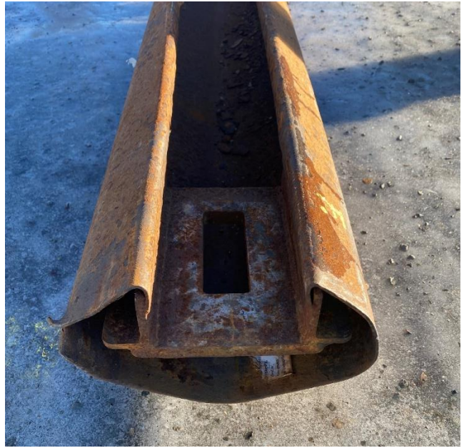
Figur 53: Underside av motsatt rekkverksende til låsen som ble funnet med håndtaket i åpen posisjon. Foto: SHK
