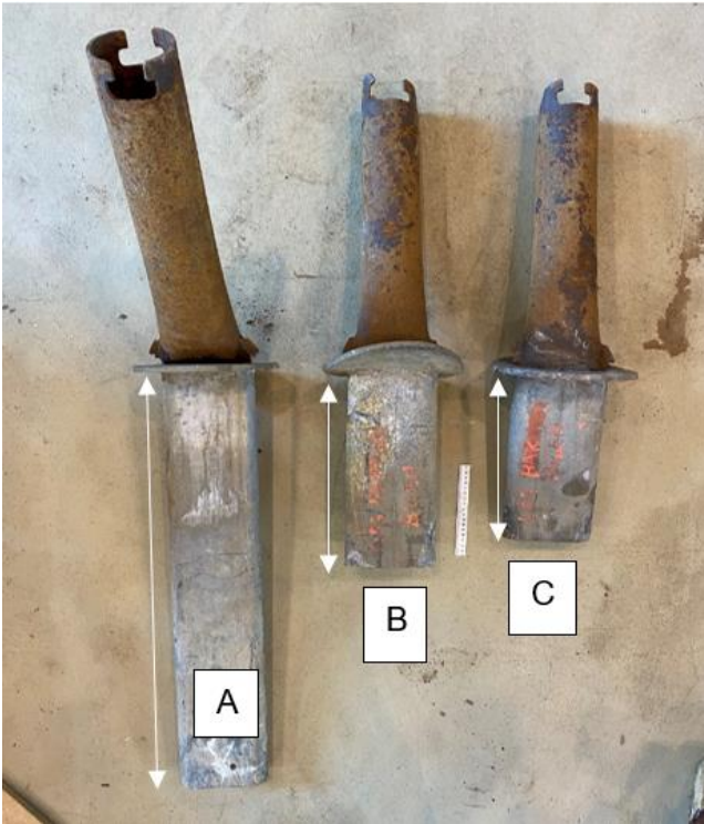
Figur 50: Ulike lengder på fundamentrørene. A: 750 mm, B: 340 mm og C: 295 mm. Foto og illustrasjon: SHK
