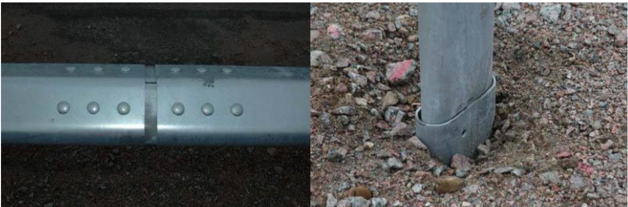
Figur 23: Testene er utførte med boltede skjøter i rekkverket og grusfundamentering av stolpene som vist på bildet til høyre. Bilde: Utklipp fra VTI testrapport nr. 56749
