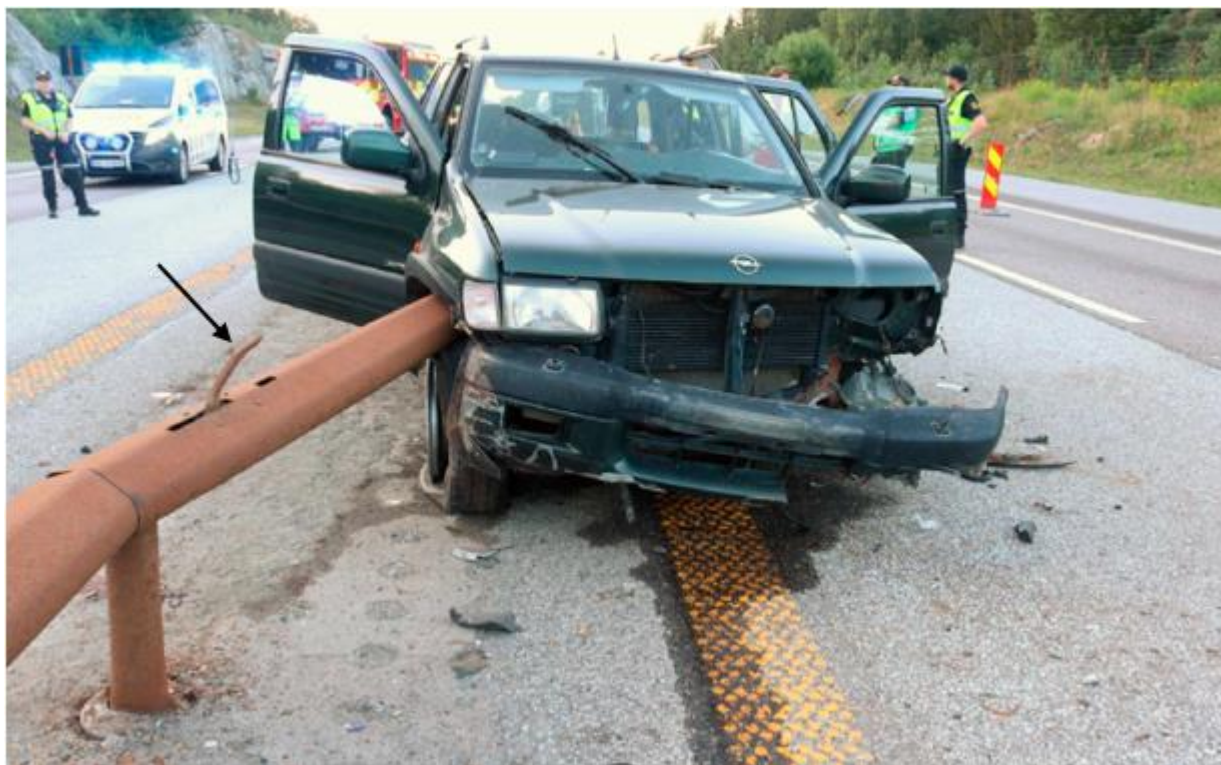
Figur 11: Rekkverkets inntrengningspunkt på bilens høyre hjulbue. Sort pil peker på et låsehåndtak i halvåpen posisjon. Foto: Statens vegvesen. Illustrasjon: SHK
