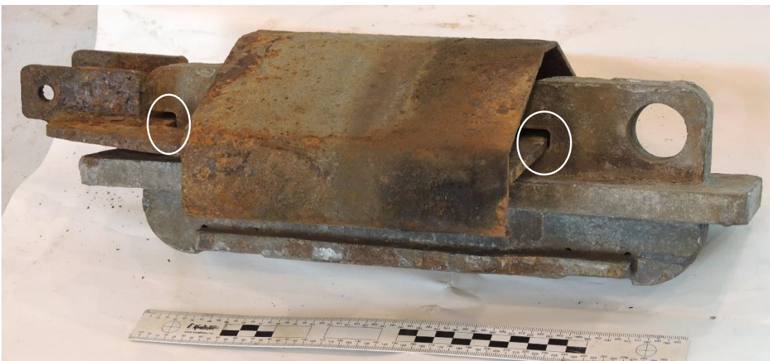
Figur 21: Glideplaten helt i inngrep i låseklossens inngrepsområder. Foto og illustrasjon: SHK
