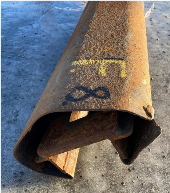
Figur 52: Overside av motsatt rekkverksende til låsen som ble funnet med håndtaket i åpen posisjon. Foto: SHK
