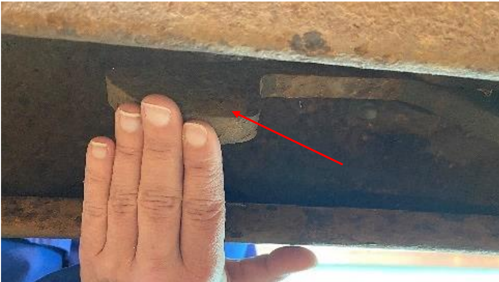
Figur 18: Sikringstapp (rød pil) ført oppover. Dette medfører frigjøring av låsehåndtaket. Foto og illustrasjon: SHK
