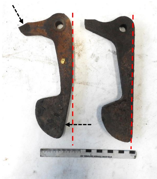
Figur 40: Deformert sikringstapp på lås nr. 5 til venstre og en intakt sikringstapp til høyre. De sorte pilene viser kraftretningene som sikringstappen har fått påført. Foto og illustrasjon: SHK
