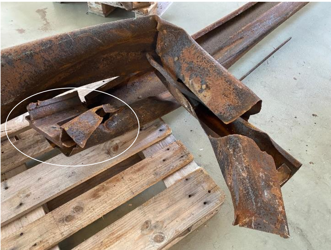
Figur 54: En rekkverksskjøt med brudd i materialet rundt låsen. Hvit ring viser materialbrudd rundt innsetningsplaten. Foto og illustrasjon: SHK
