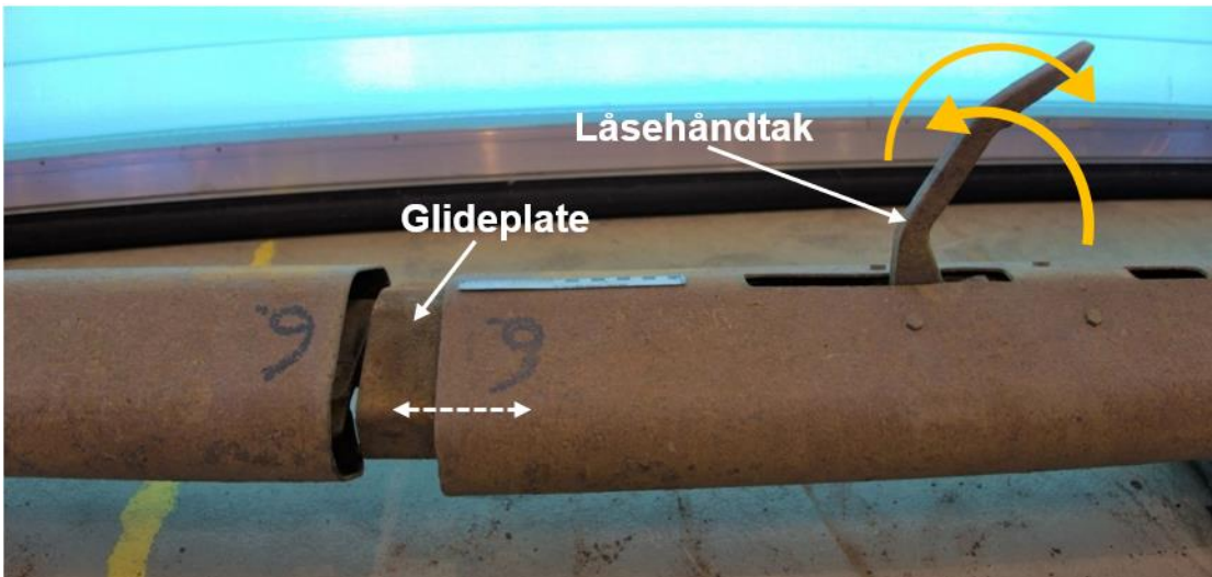
Figur 19: Låseanordningen på rekkverket. Glideplaten forskyver seg til høyre, inn i egen rekkverksdel når låsehåndtaket dras opp og skjøten åpner seg. Glideplaten forskyver seg over inn i motsatt rekkverksdel når håndtaket dras nedover og skjøten lukkes. Foto og illustrasjon: SHK
