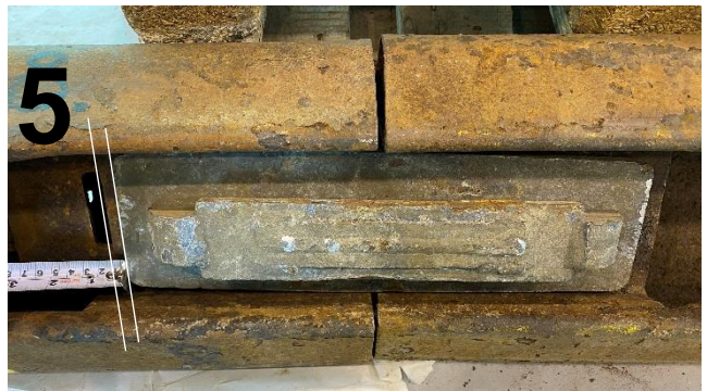
Figur 46: Låseklossens venstre inngrepsdel posisjonert lengst mot venstre. Foto og illustrasjon: SHK
