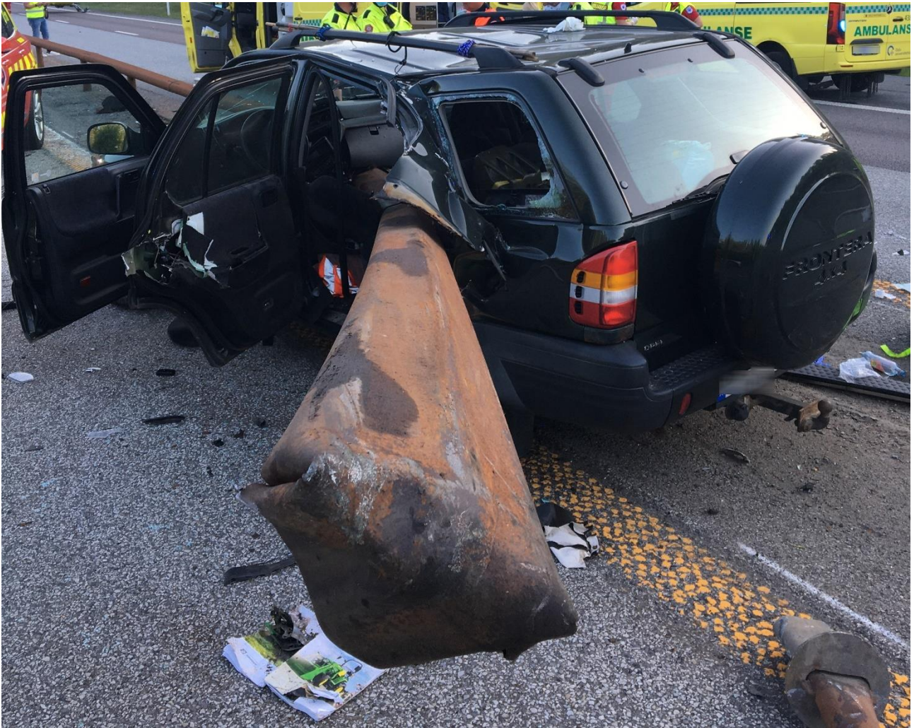
Figur 3: En 6 meter lang rekkverkslengde penetrerte personbilen. Foto: Politiet
