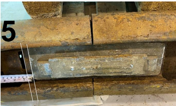
Figur 45: Låseklossens venstre inngrepsdel posisjonert lengst mot høyre. Foto og illustrasjon: SHK
