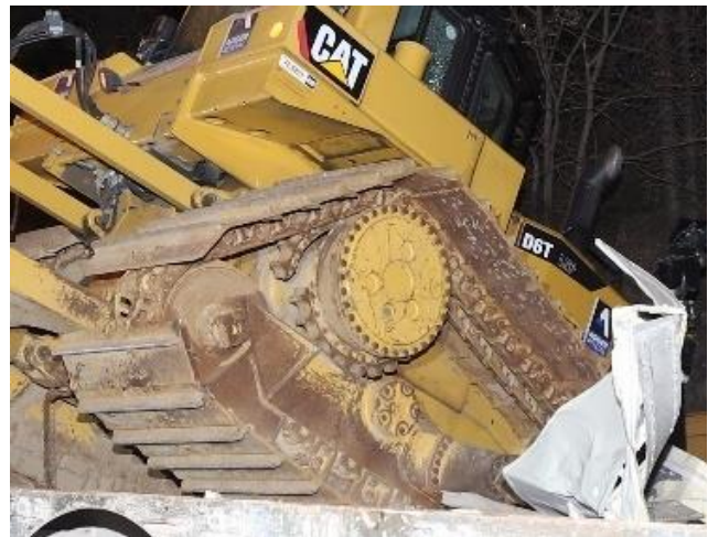
Figur 21: Knekt tannhjul og avrevet belteklakk bak. Foto: Politiet
