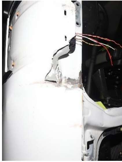
Figur 24: Avrivning ved A-stolpe, 1,66 m over bakken. Foto: Politiet
