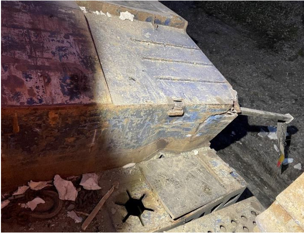
Figur 14: Deformasjon på galleri og gulv fremme på høyre side tilhenger. Høyre sidemarkeringsskilt var deformert. Foto: Politiet
