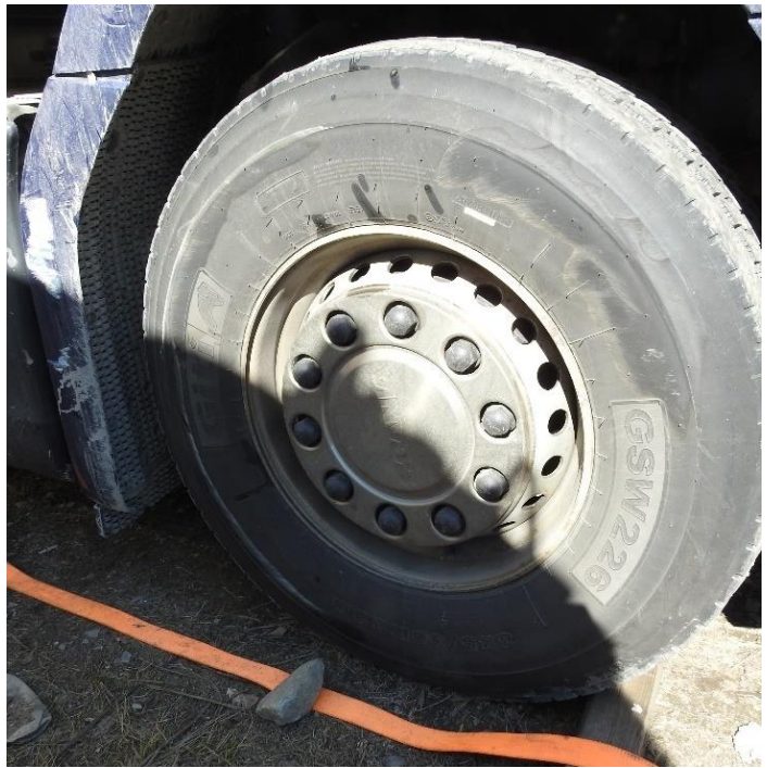
Figur 27: Skrapemerker på høyre framdekk og bakre del av skjerm. Foto: SHK
