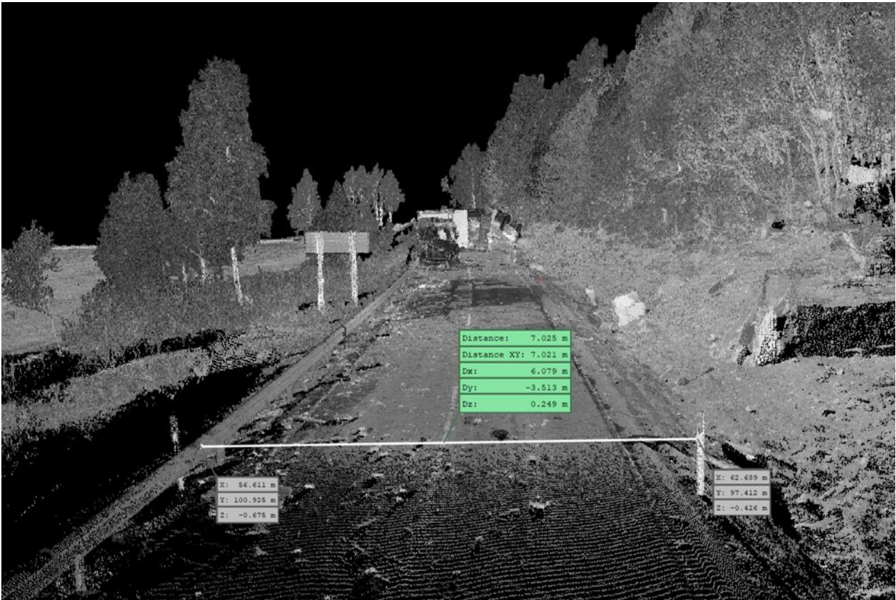
Figur 28: Bredder fra ytterkant av kantstolpe i nordgående og rekkverk i sørgående kjørefelt. Kilde: Statens vegvesen, uttak av mål: SHK
