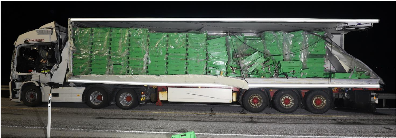
Figur 22: Trekkvogn og kjøletilhenger der førerdør og venstre sideskap var revet bort. Foto: Politiet
