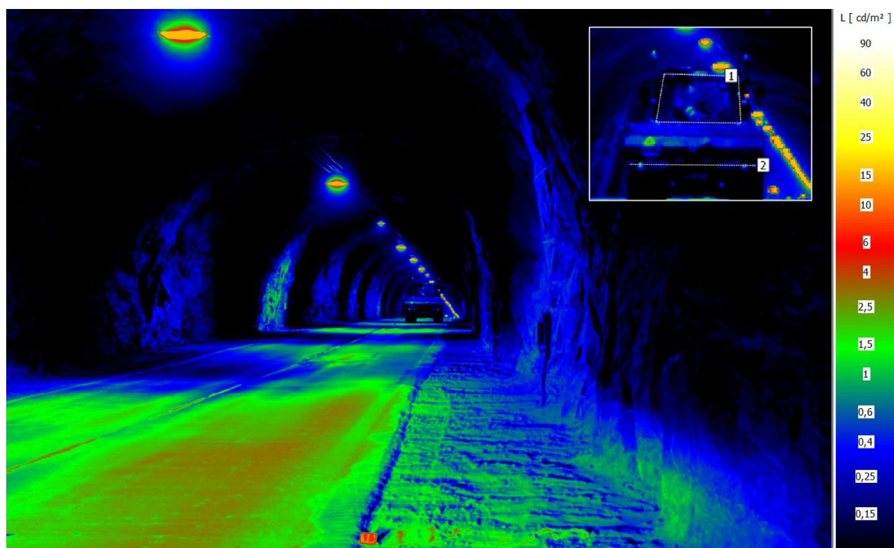
Figur 44: Same scenario som figur 43, der Norconsult har målt gjennomsnittlege luminansverdier på traktorhytta til 0,20 cd/m 2 og nedst på tilhengar til 0,20 cd/m 2 . Foto: Norconsult
