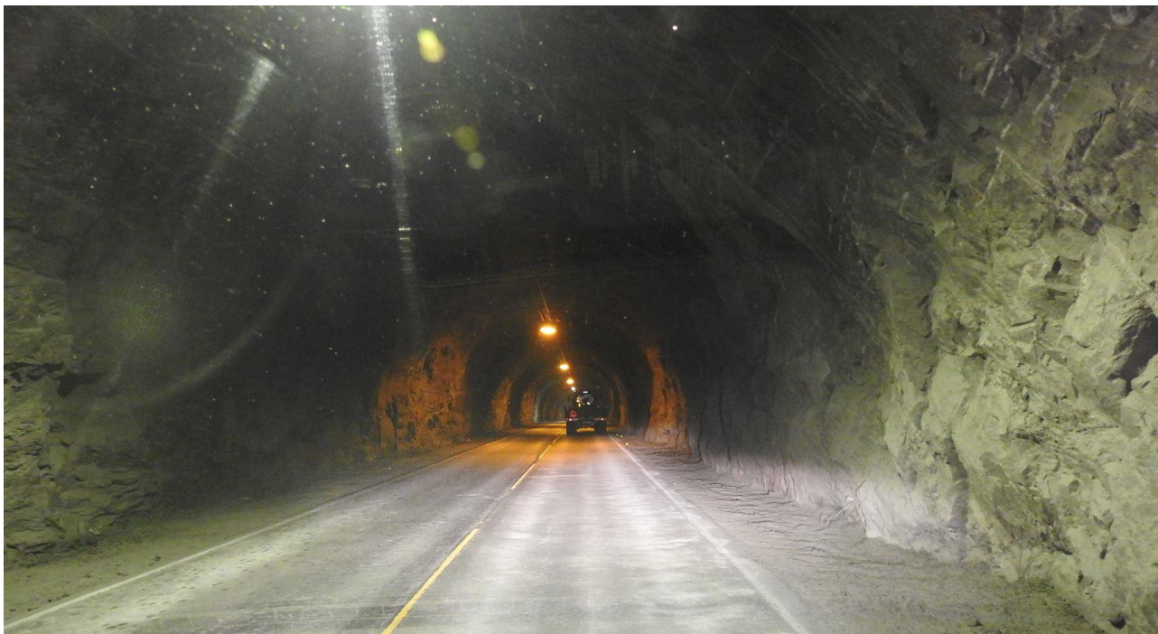
Figur 39: Bakkant av tilhenger plassert midt mellom to lysarmaturer (mørk sone), 45 meter framfor personbilen, utan lys på traktor og tilhenger. Nærlys på personbilen. Det var armatur med kvitt lys rett framfor bilen. Foto: SHK
