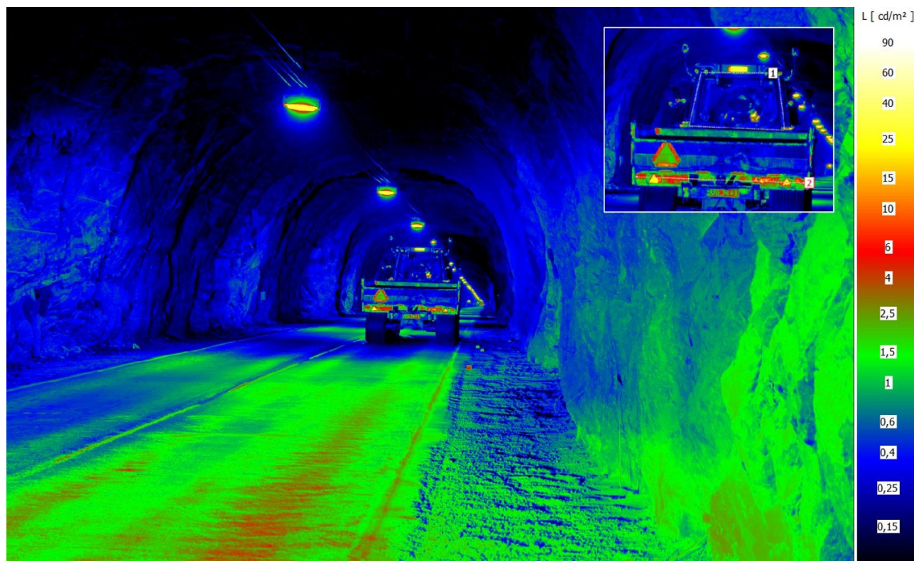
Figur 42: Same scenario som figur 41, der Norconsult har målt gjennomsnittlige luminansverdier på traktorhytta til 0,46 cd/m 2 og nedst på tilhenger til 5,26 cd/m 2 . Foto: Norconsult
