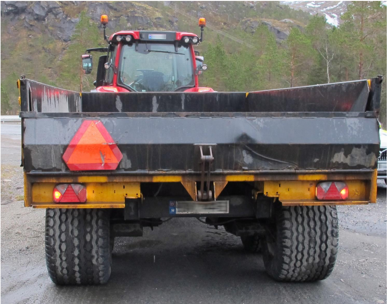
Figur 16: Traktoren med tilhenger, som blei brukt til å undersøke kor godt han synte i tunnelen, hadde baklys, ein raud refleks på kvar side og eit raudt reflekterande varselskilt på baklemmen. Foto: SHK
