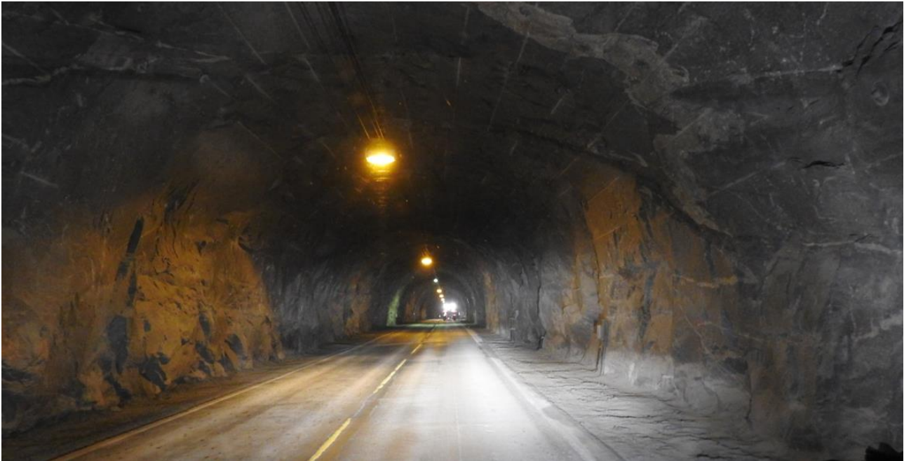
Figur 29: Bakkant av tilhenger plassert midt mellom to lysarmaturar (mørk sone), 115 meter framfor personbilen, bak- og arbeidslys bak på traktor. Ikkje lys på tilhenger. Fjernlys på personbilen. Foto: SHK
