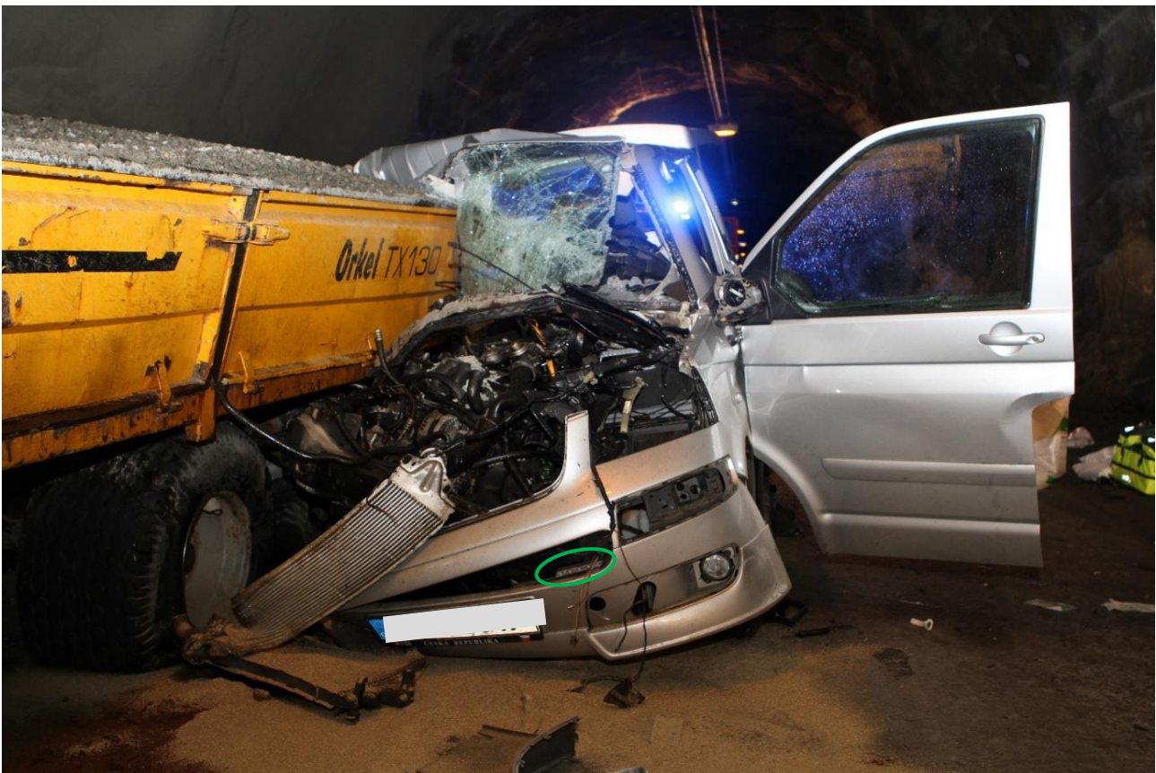
Figur 8: Skadeomfanget. Den grønne ringen viser ettermonterte køyrelys på venstre side, jf. kapittel 1.8.2. Illustrasjon: SHK. Foto: Politiet
