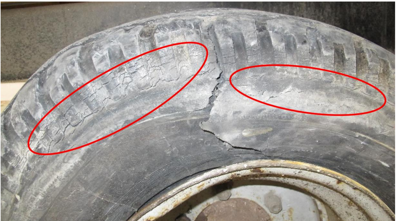
Figur 14: Sprekkar i venstre dekk framme på tilhengaren, sjå dei raude sirklane. Flenga er sannsynlegvis frå kollisjonen. Foto og illustrasjon: SHK
