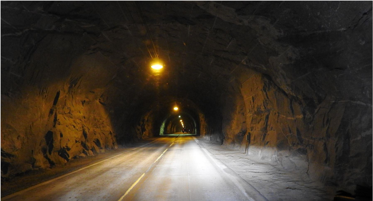
Figur 35: Bakkant av tilhenger plassert midt mellom to lysarmaturar (mørk sone), 115 meter framfor personbilen, utan lys på traktor og tilhenger. Nærlys på personbilen. Foto: SHK
