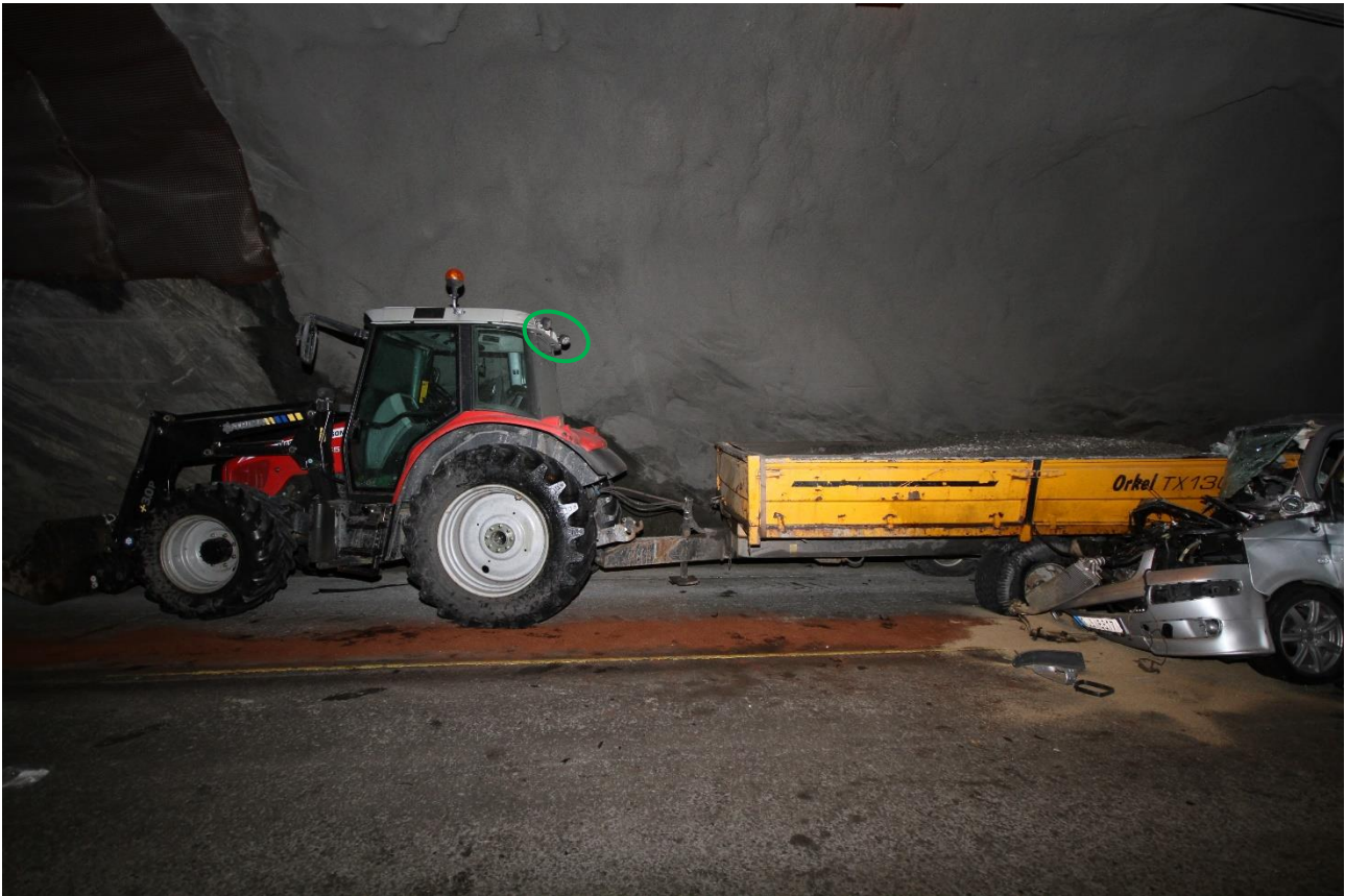
Figur 7: Ulukkesstaden og sluttposisjonane til køyretøya. Den grønne ringen viser arbeidslyset på traktoren. Illustrasjon: SHK. Foto: Politiet
