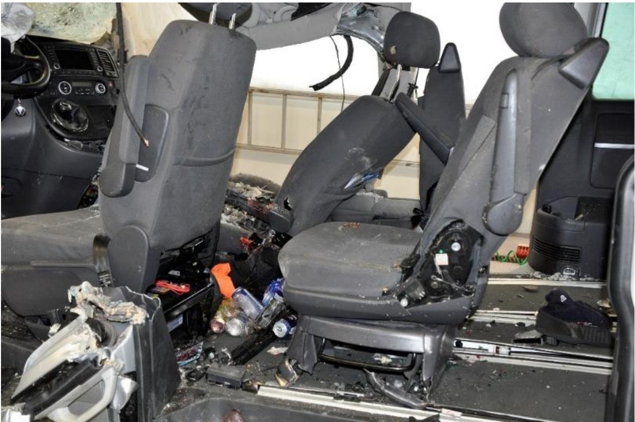
Figur 2: Innvendige skadar, flytting av sete og seteryggar i personbilen. Foto: SHK
