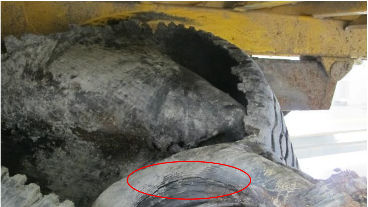
Figur 13: Sprekkar i venstre bakre dekk på tilhengaren som punkterte, sjå den raude sirkelen. Foto og illustrasjon: SHK
