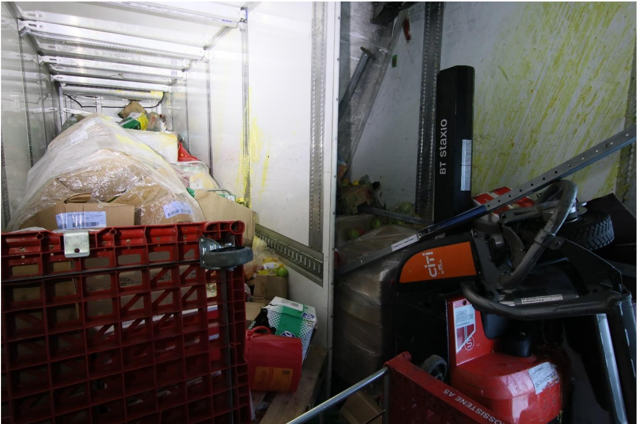
Figur 19: Lastens plassering etter berging. Den elektriske jekketralen ligger oppå den elektriske stabletrucken til høyre i bildet. Foto: Politiet
