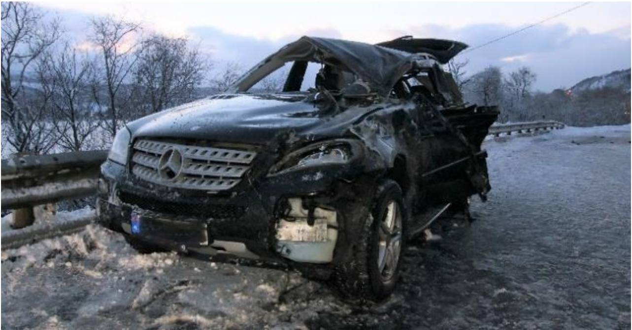
Figur 11: Skader på venstre del av personbilens front, panser, tak, A-stolpe og B-stolpe. Bildet er tatt etter frigjøringsarbeidet, og er lysjustert. Foto: Politiet
