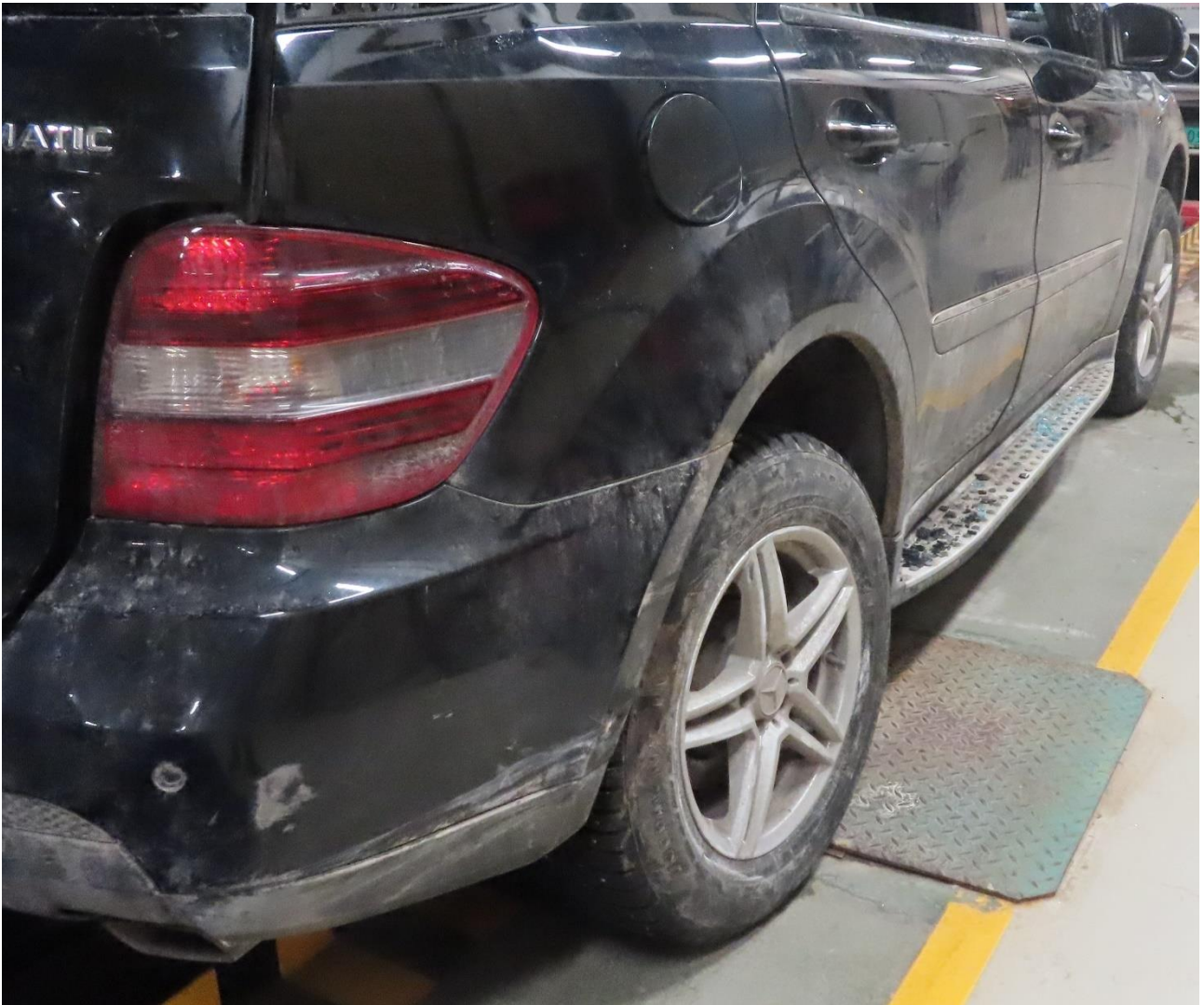
Figur 13: Skader på personbilens høyre bakhjul og skjerm. Foto: Statens vegvesen
