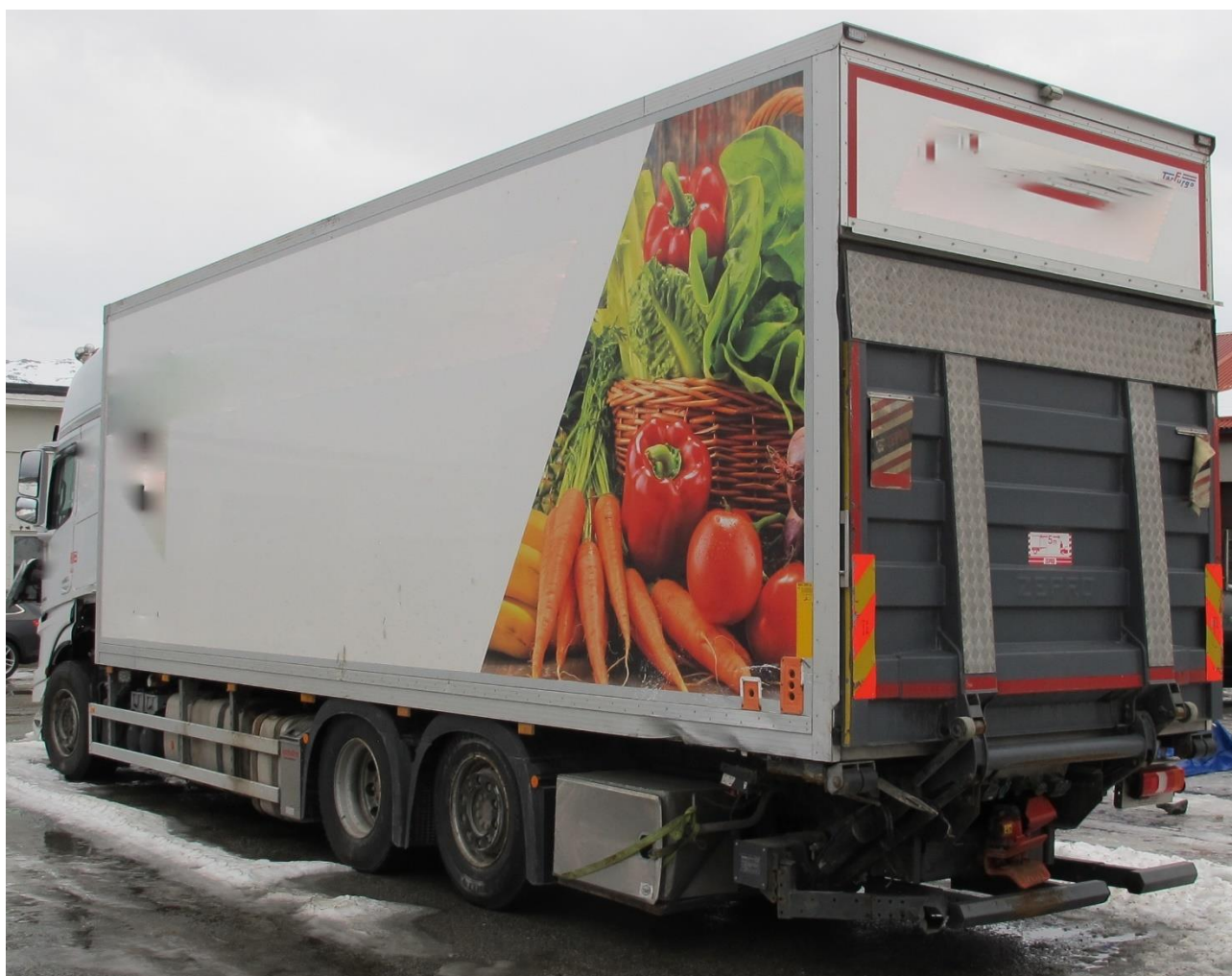
Figur 9: Skader nederst på den venstre bakre siden av lastebilens skappåbygg. Utstyrsskapet bak akslingen og den venstre delen av underkjøringshinderet bak var også skadet. Bildet er tatt etter bergingsarbeidet. Foto: SHK
