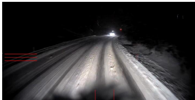
Figur 5: Den øverste horisontale hjelpelinjen ligger langs autovernets nedre del. Foto: Dashbordkamera i lastebilen. Illustrasjon: SHK
