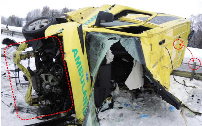
Figur 6: Skader i front og treffpunkt i taket mot rekkverkstolpe etter at ambulansen nesten rullet over på taket. Bildet er tatt etter frigjøring av fører. Foto:SHK
