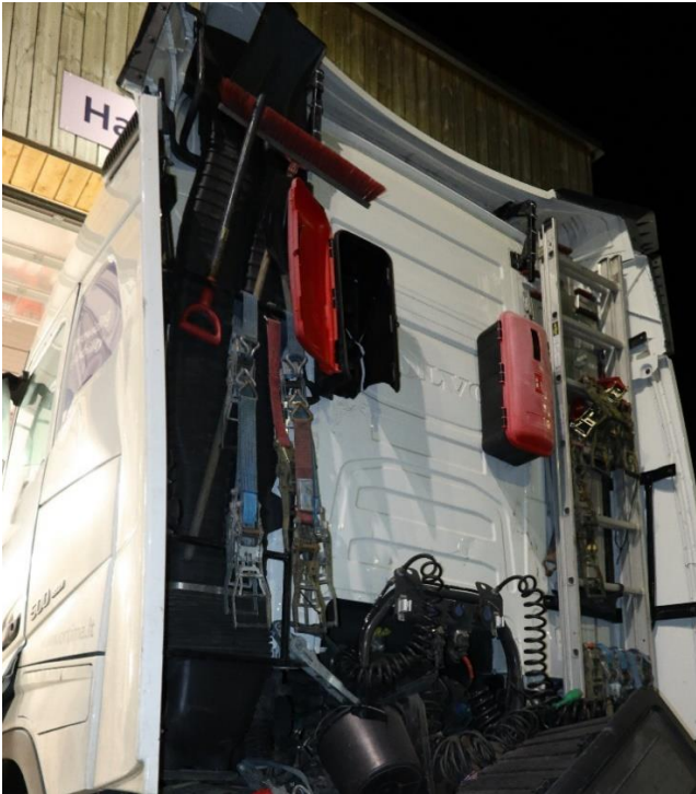
Figur 8: Skapet til den ene brannslukkeren på trekkbilens bakvegg ble skadet. Foto: SHK
