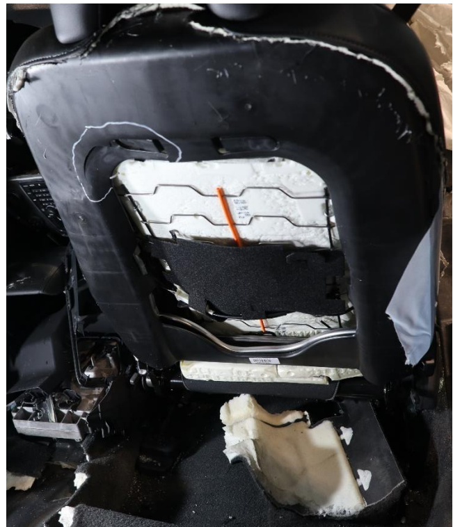
Figur 21: Skader på ryggen til passasjerasetet foran, som var synlige bak setets polstring, er markert med hvitt kritt. Foto: SHK
