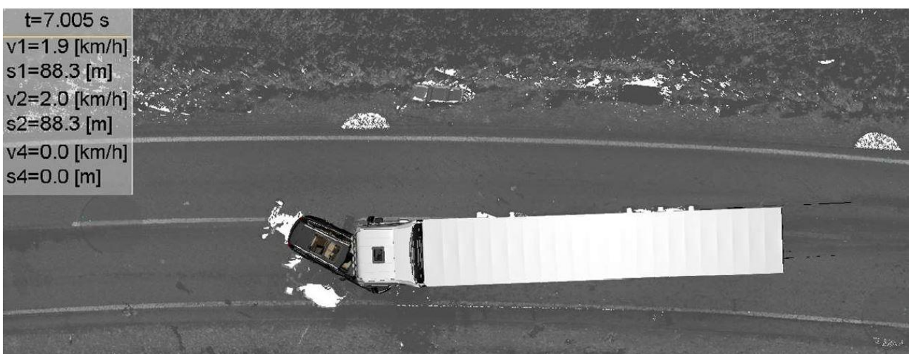
Figur 29: Oversiktsbilde av sluttposisjon til kjøretøyene etter at vogntoget har presset personbilen bakover. Foto og illustrasjon: Statens vegvesen
