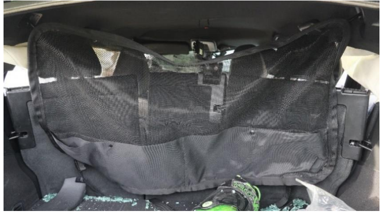
Figur 23: Beskyttelsesnettets innfesting etter kollisjonen. Foto: SHK
