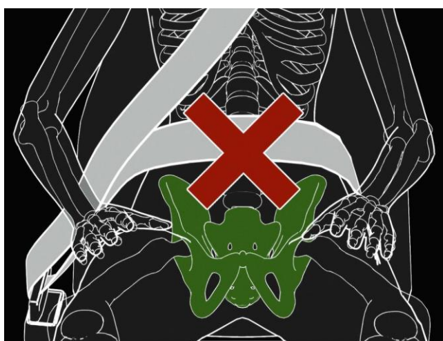
Figur 33: Feil plassering av hoftebelte på bilbeltet. Illustrasjon: SHK
