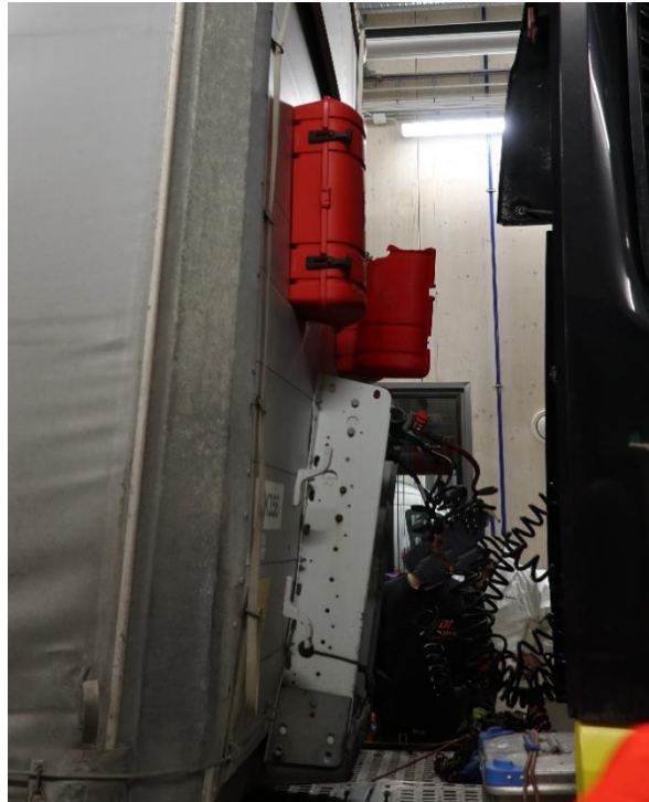
Figur 9: Semitrailerens framvegg ble presset framover, men forble festet til gulvet. Skapet til den ene brannslukkeren ble skadet. Foto: SHK
