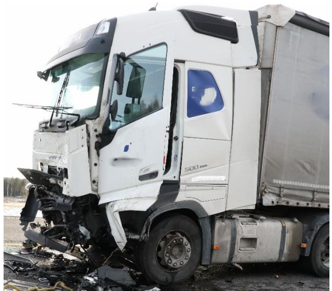
Figur 7: Vogntoget sett fra venstre. Semitraileren ble presset fram mot trekkbilen i kollisjonen. Foto: SHK
