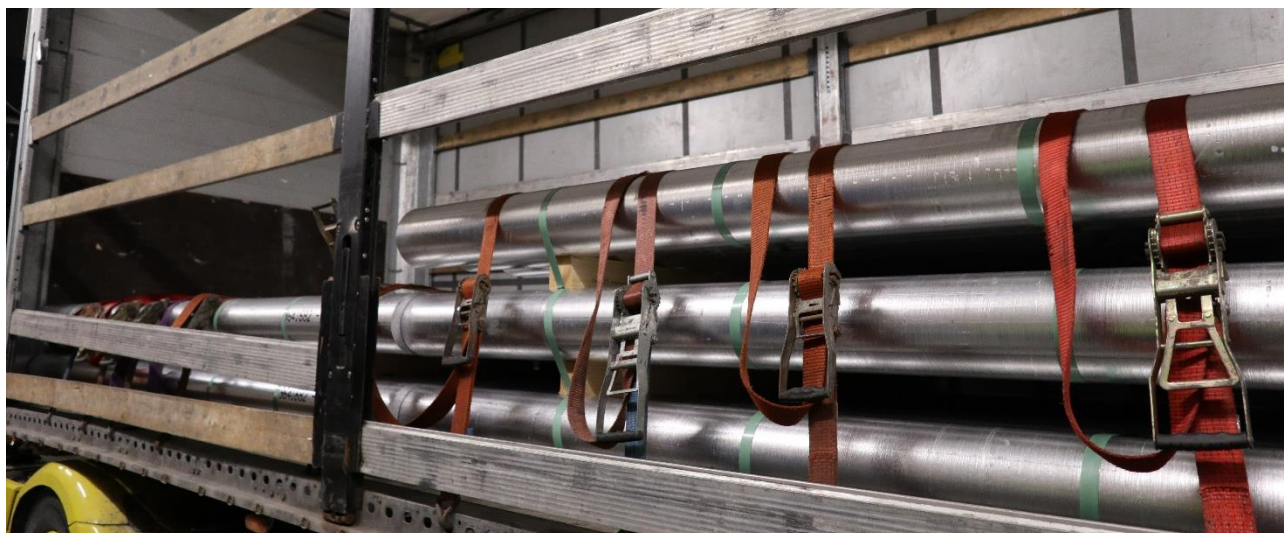
Figur 12: Lasten som bestod av aluminium ble forskjøvet framover i kollisjonen. Strammebåndene som sikret lasten var i orden. Foto: SHK
