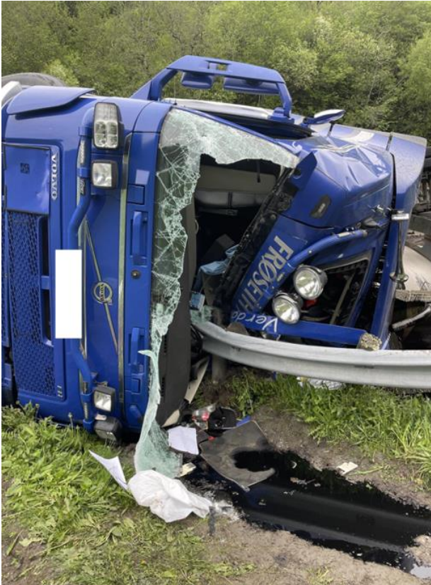
Figur 3: Siderekkerket trengte inn i førerhytta og taket på førerhytta ble klemt ned som følge av velten. Foto: Politiet. Sladdet registreringsnummer: SHK
