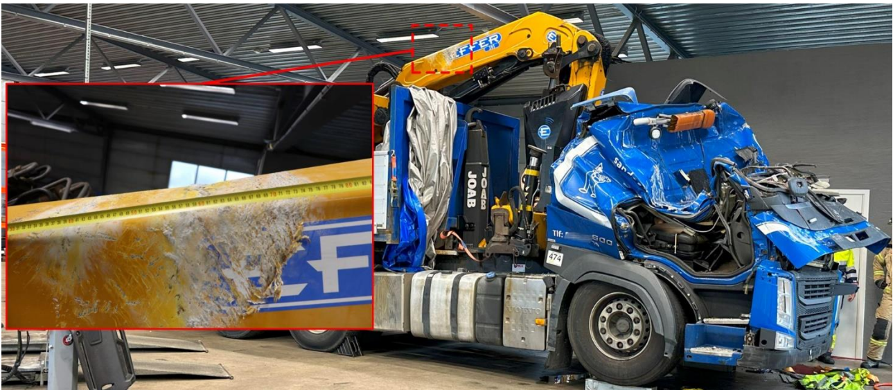
Figur 7: Skadar på lastebilen og kranarmen etter ulykka og berginga. Foto og illustrasjon: SHK
