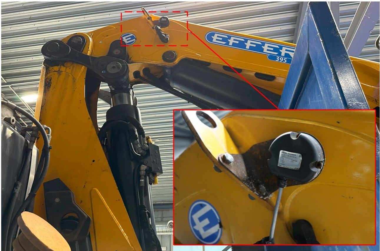
Figur 18: Plassering og utforming av vinkelsensoren på hovudarmen. Foto og illustrasjon: SHK
