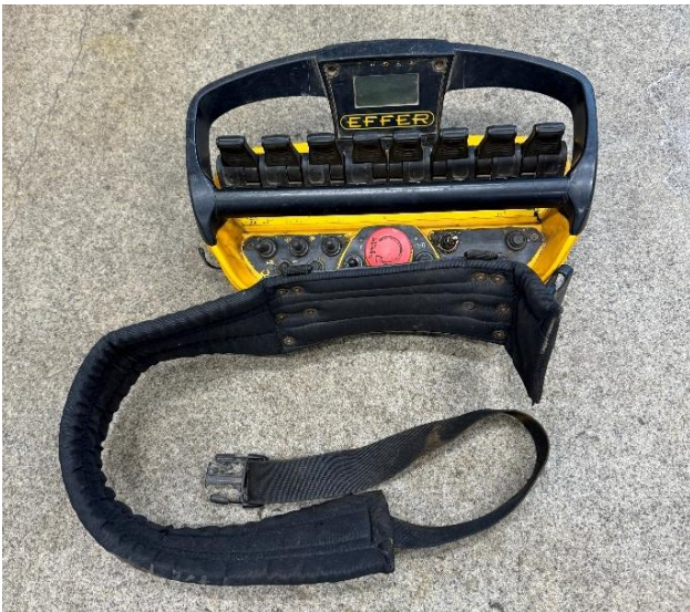
Figur 11: Fjernkontrollen til kрана med magebelte. Foto: SHK.
