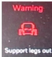
Figur 20: Symbol for varsling av støttebein ute i dashbordet til ein Volvo lastebil, 2023-modell. Foto: SHK
