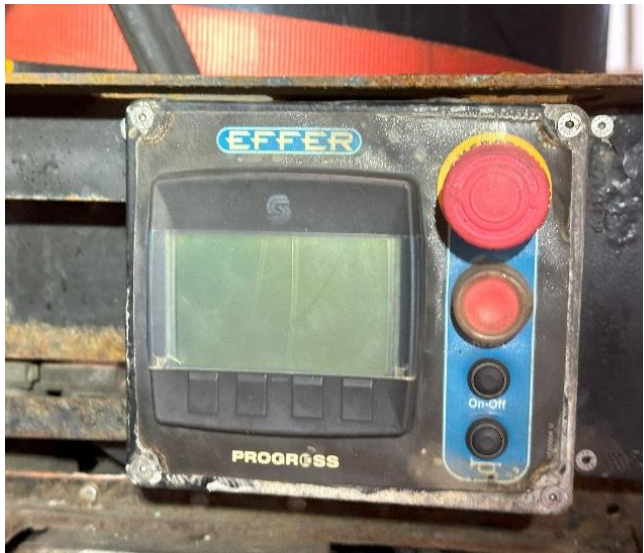
Figur 12: Kontrollpanelet ved kрана. Foto: SHK.
