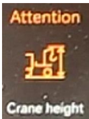
Figur 19: Symbol for varsling av kranhøgde i dashbordet til ein Volvo lastebil, 2023-modell. Foto: SHK
