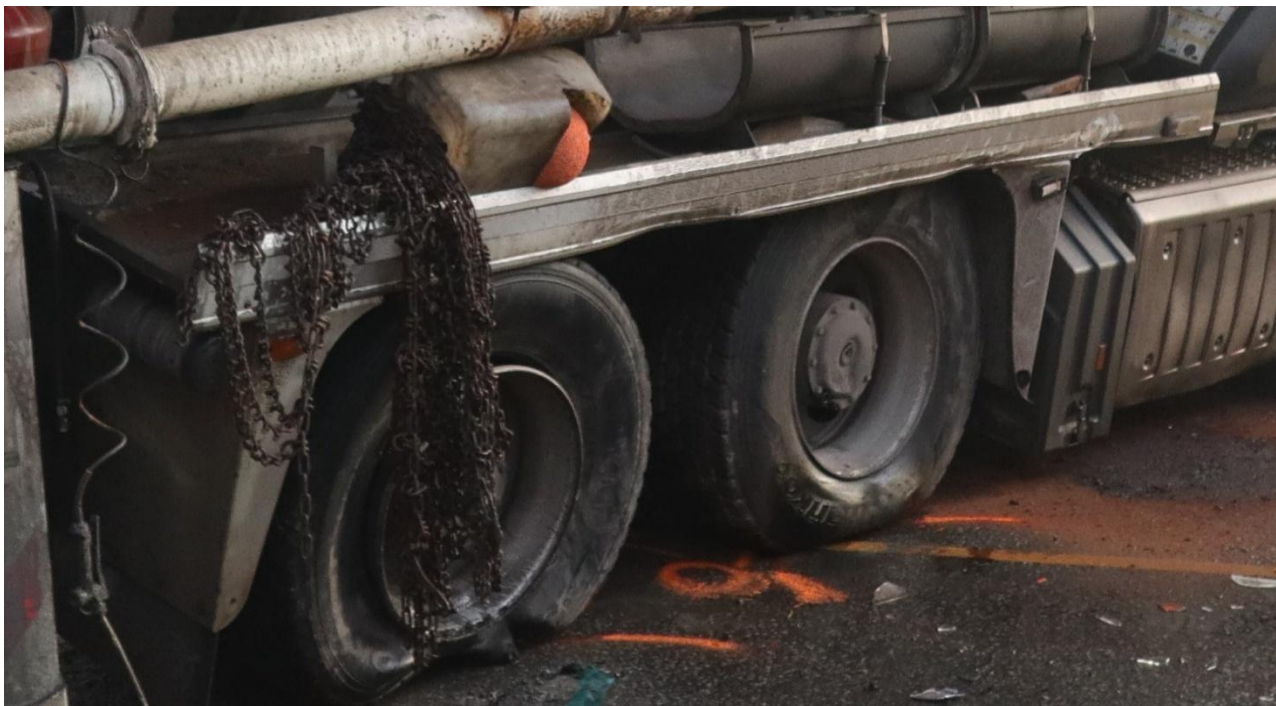
Figur 5: Skader i listen langs planet på betongbilens høyre side. Felgen på bakerste aksel var skadet, og det ytterste tvillingdekket var punktert Foto: SHK
