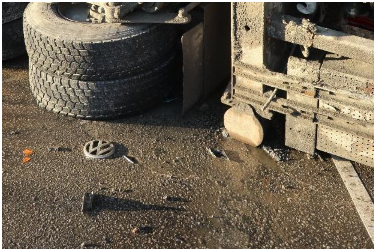
Figur 15: Varebilens frontemblem, og spor i asfalten etter betongbilens bakre høyre støttelabb. Foto: SHK
