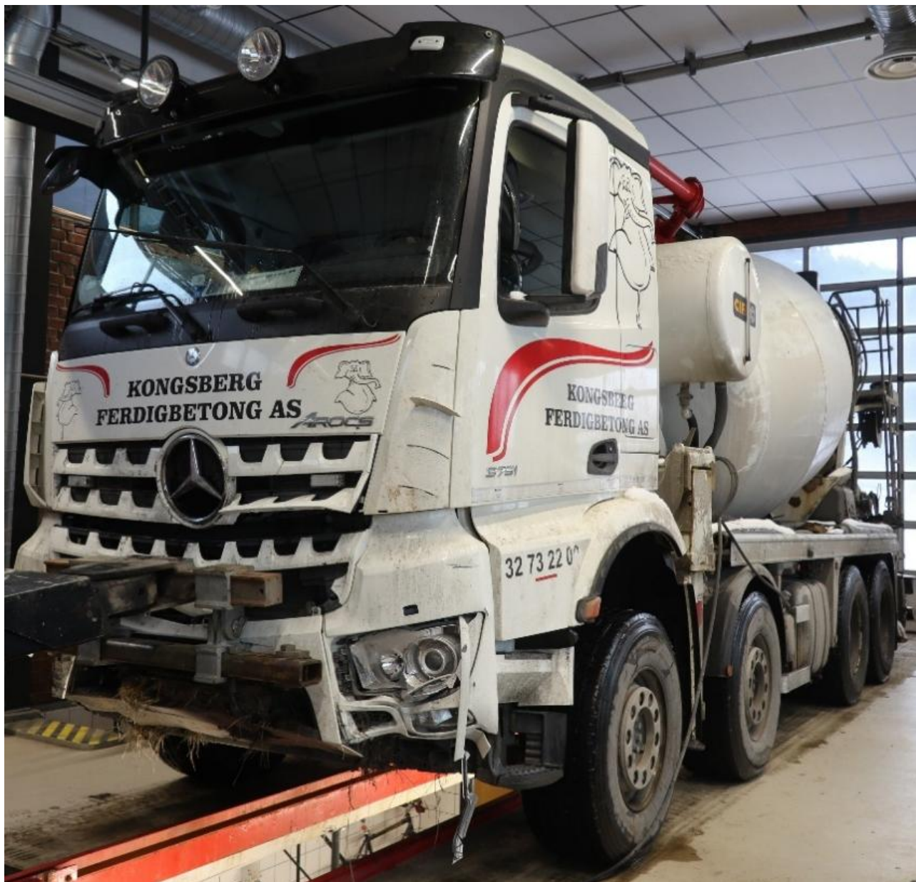
Figur 3: Skader og rester fra terrenget i fronten på betongbilen. Foto: SHK
