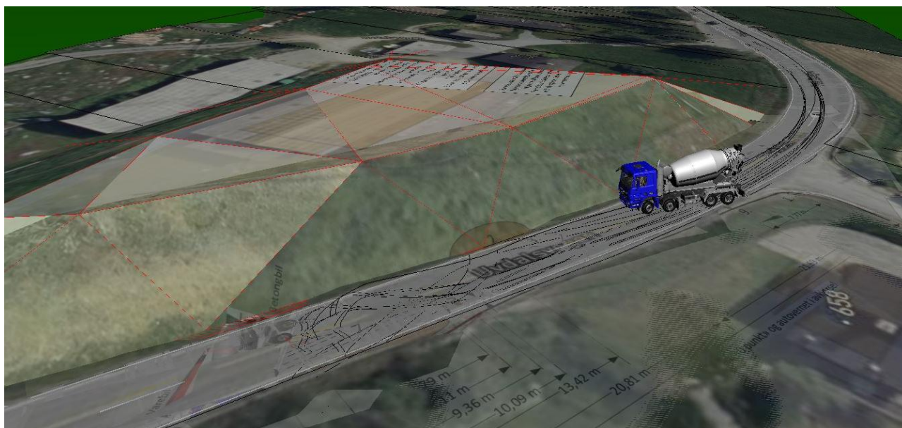
Figur 39: Simulering av betongbilens rotasjon med klokken på veibanen, og betongbilens treff mot rekkverket på venstre side av veien. Illustrasjon: SHK
