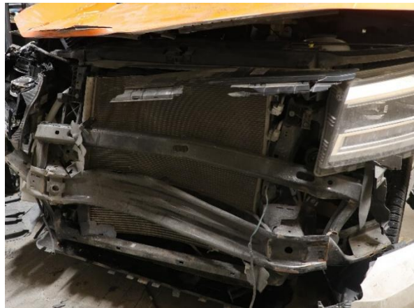
Figur 7: Innpress i støtfanger og høyre rammevange. Foto: SHK
