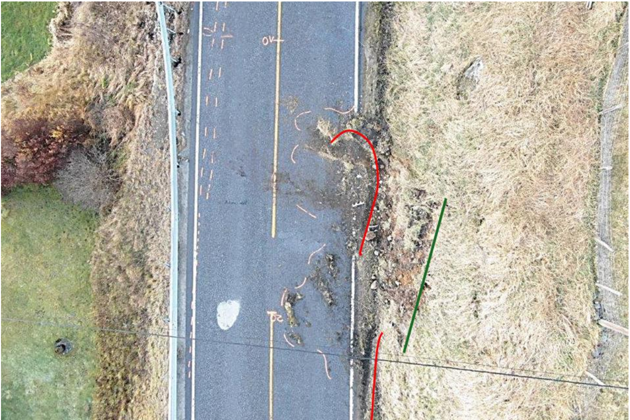
Figur 10: Spor i sideterrenget på høyre side av veibanen. De røde linjene viser spor etter hjul. Den grønne linjen viser spor høyere oppe i sideterrenget etter betongbilens front. Foto: Statens vegvesen. Illustrasjon: SHK
