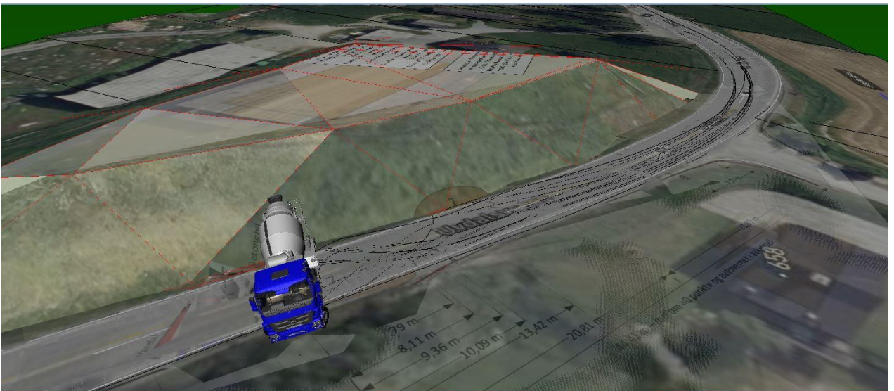
Figur 41: Simulering av betongbilens stans like før den veltet. Illustrasjon: SHK
