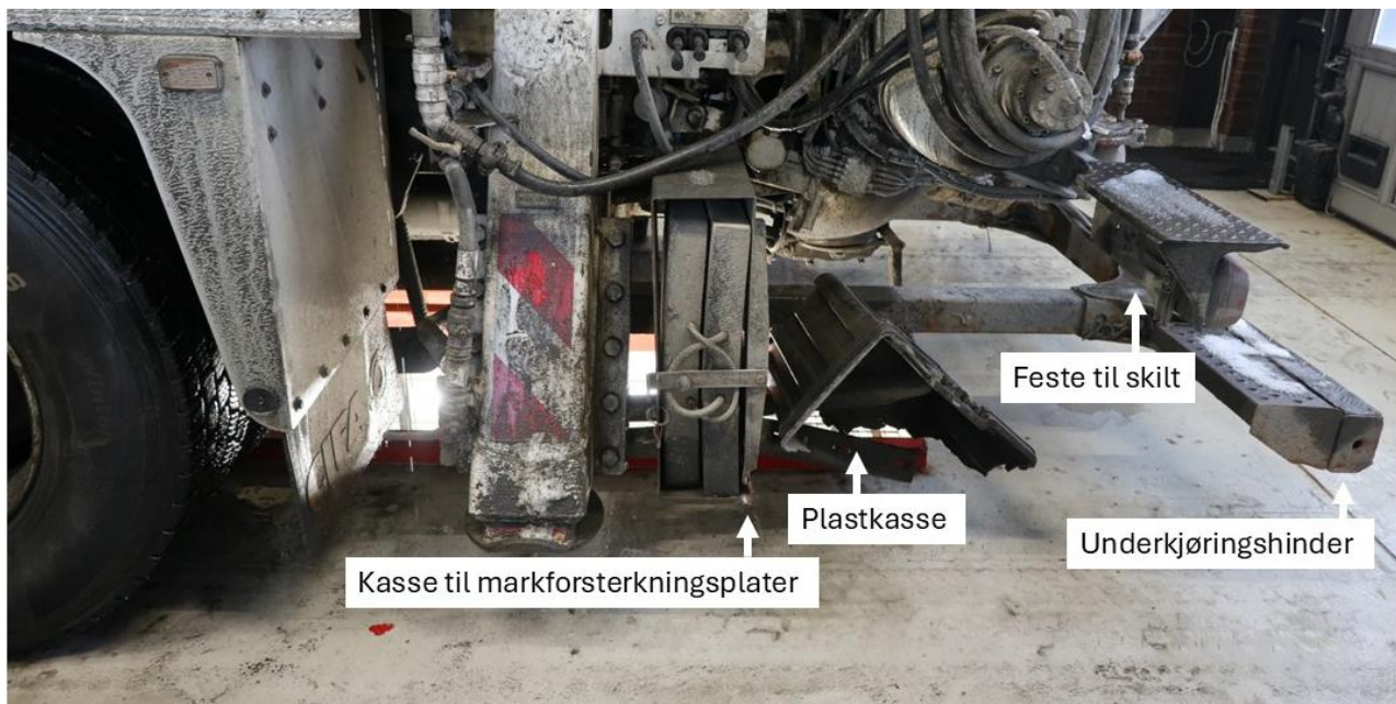
Figur 4: Skader bak på venstre del av betongbilen. Foto og illustrasjon: SHK
