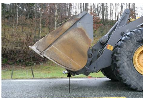
Figur 7: Bildet viser høyde på lasteskuffen målt til 0,56 m til nedre skuffekant. (foto: Politiet)
