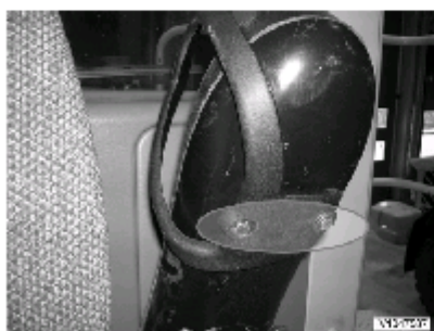
Fig.2 Styrspak med skyddsbygel Cirkeln indikerar skruvarna som håller ihop armstödet.
