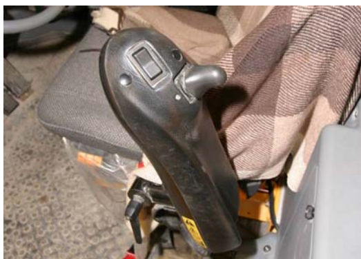
Figur 14: Viser armlene med styrespak og aktiveringsknapper. På utsiden av armlenet vises faresymbol som gult merke.
