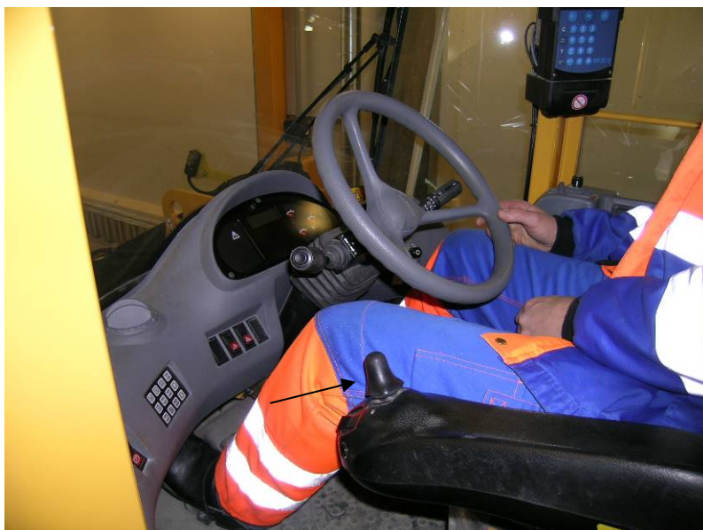
Figur 1: Bilde av førermiljø med pil som viser "spak" som betjener CDC-styringen.
