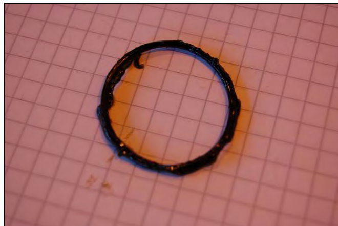
Figur 13: Viser bilde av skadet O-ring
