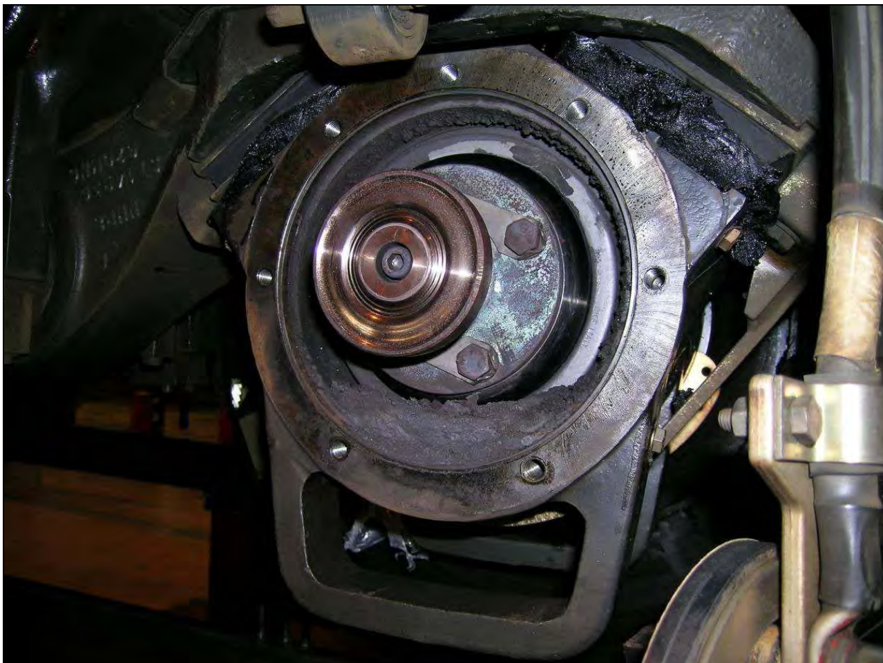
Figur 15: Lager som ble skadet av varmgang. Det er avleiret store støvmengder og primærfjæring av gummi har smeltet. Kontaktskiven som vises midt på bildet er betydelig slitt.
