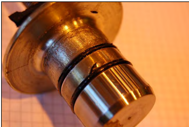
Figur 12: Akseltapp for tetting av hulrom i aksel.
