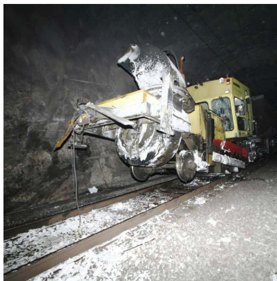
Figur 4: Bilde av snøsuget, sett fra lastetraktoren, etter sammenstøtet.
