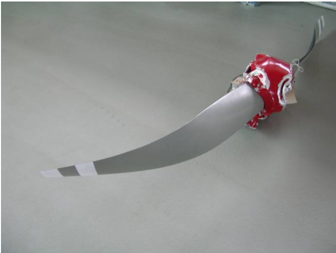
Figur 2: Høyre propellblad. Bøyd bakover og vridd
