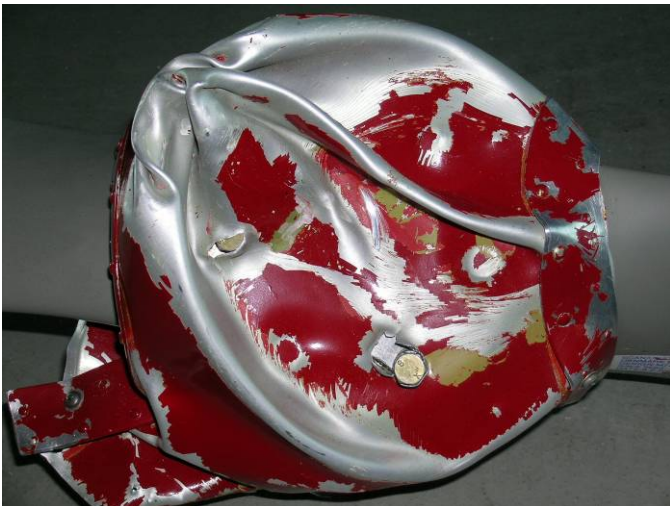
Figur 4: Spinner. Propellbolter presset gjennom metallet
