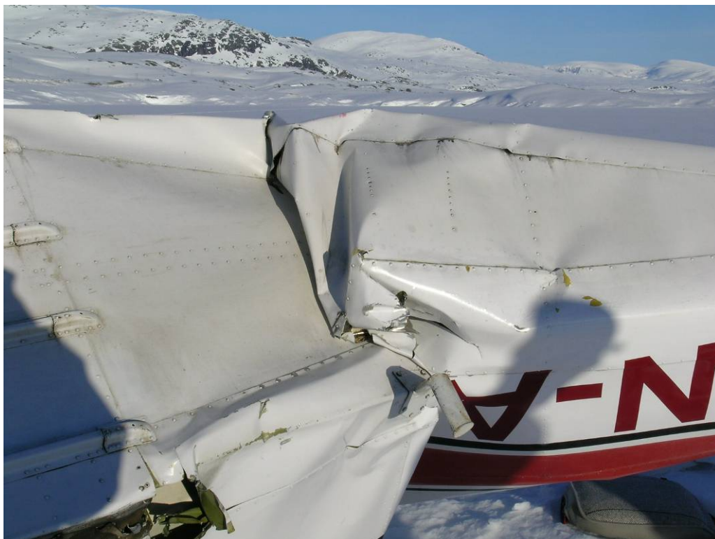
Figur E4: Kompresjon av skroget bak kabinen. Knekk mot høyre.
