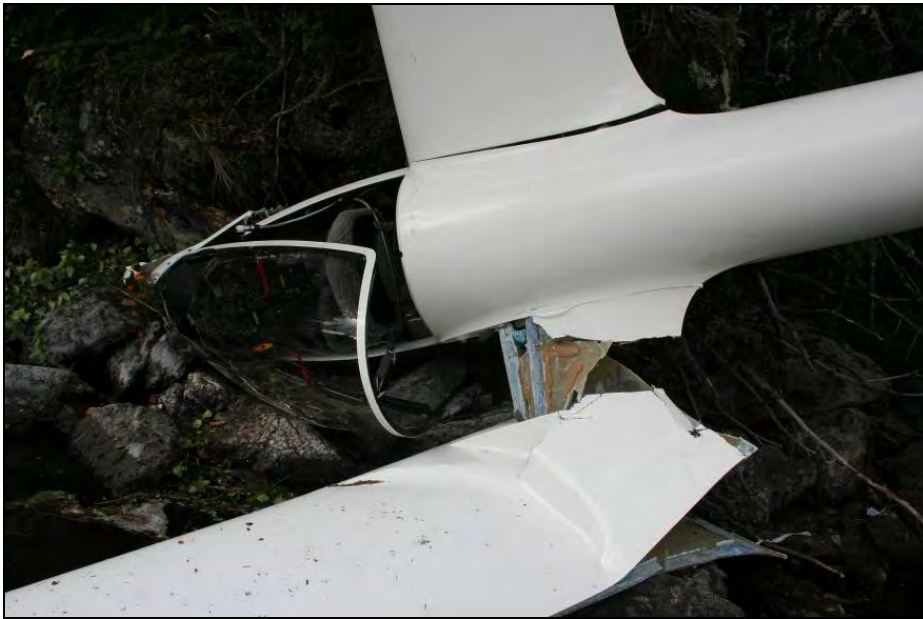
Figur 5: Venstre vinge var brukket ved vingeroten.
