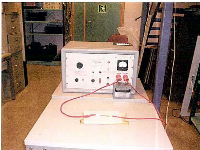
Figur 11 Oversiktsbilde av forsøksoppsett (Spike Generator "model 7399-2").
