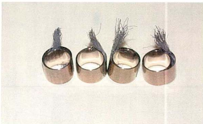
Figur 6 Oversiktsbilde av prøver tatt ut fra kabel merket A i Figur 1 for vurdering av bruddflater.
