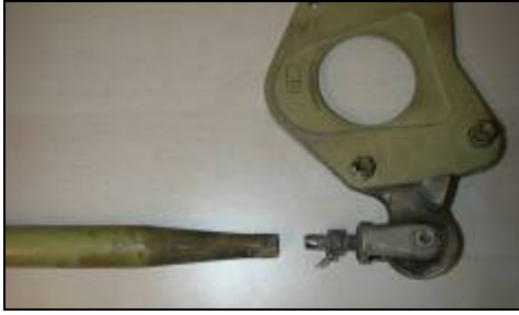
Figur 7: Brutt stagoverføring til høyderor
