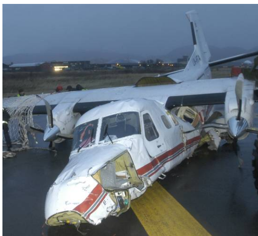
Figur 12: Komprimert kabin (foto tatt av forsvaret)
