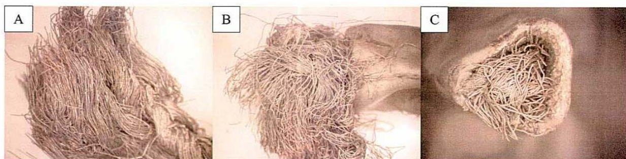
Figur 2 Bilder tatt i stereomikroskop av de ulike kablene vist i Figur 1 (merket tilsvarende).
