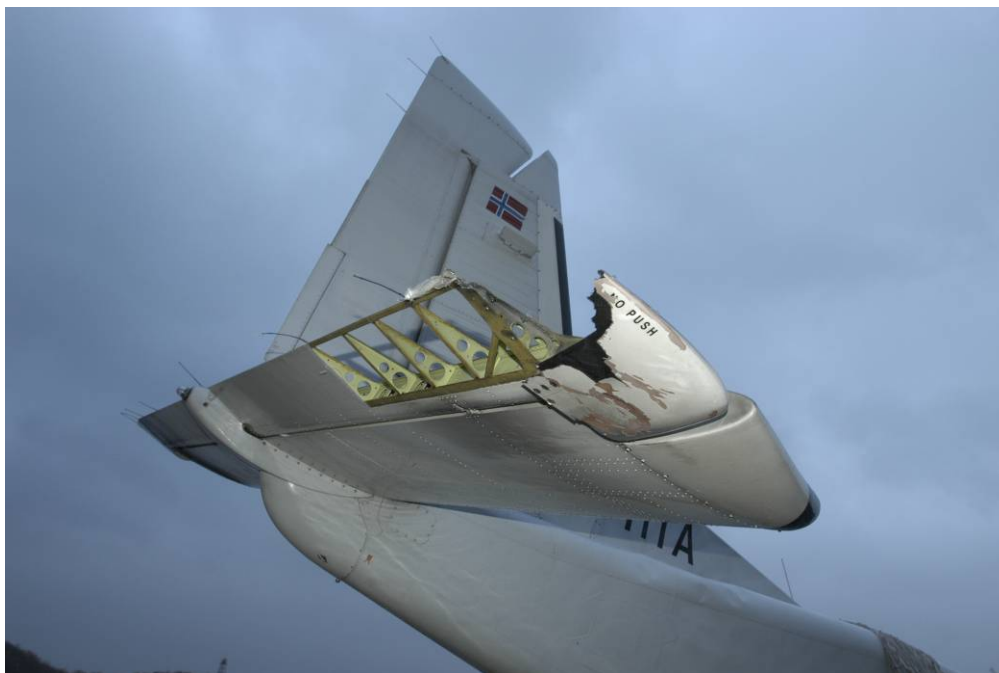
Figur 6: Skadet høyre høyderor (foto tatt av forsvaret)
