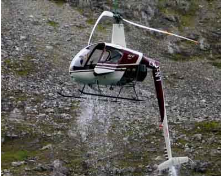
Figur 12: LN-OCI berging (venstre frontvindu er knust, døren er åpen).
