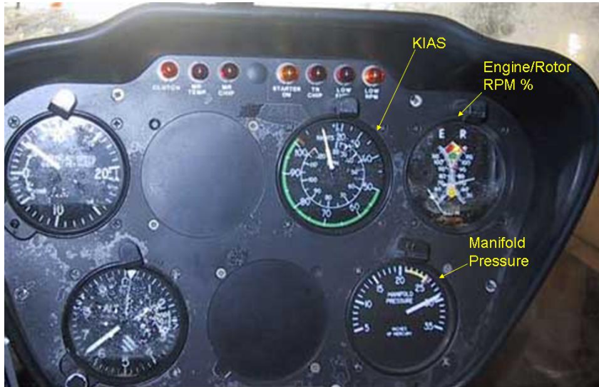
Figur 11: Hastighetsindikator (KIAS) – motor- og rotorturteller (Engine/Rotor RPM) og innsugningstrykkmåler (MP)
