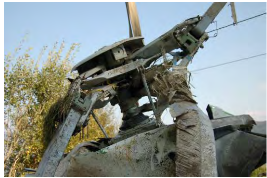
Figur 8: Rotorhode med splintret bladinnfesting.
