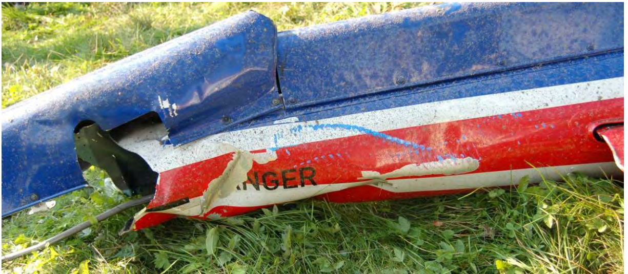
Figur 4: Skrapemerker på bakre del av halebom, høyre side.
