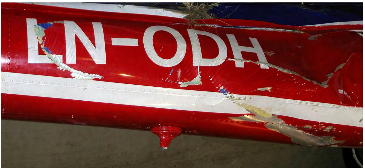
Figur 5: Skrapemerker på midtre del av halebom, høyre side.
