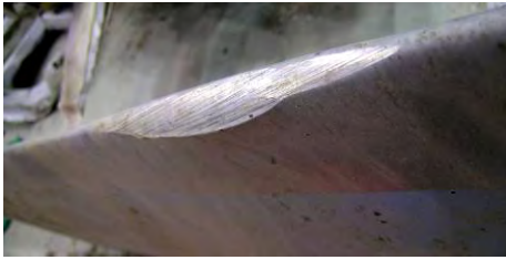
Figur 7: Skrapemerker på forkant av hovedrotorblad.
