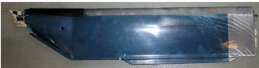
Figur 10: Halerotorbladet som ble funnet separat, lengst unna havaristedet.
