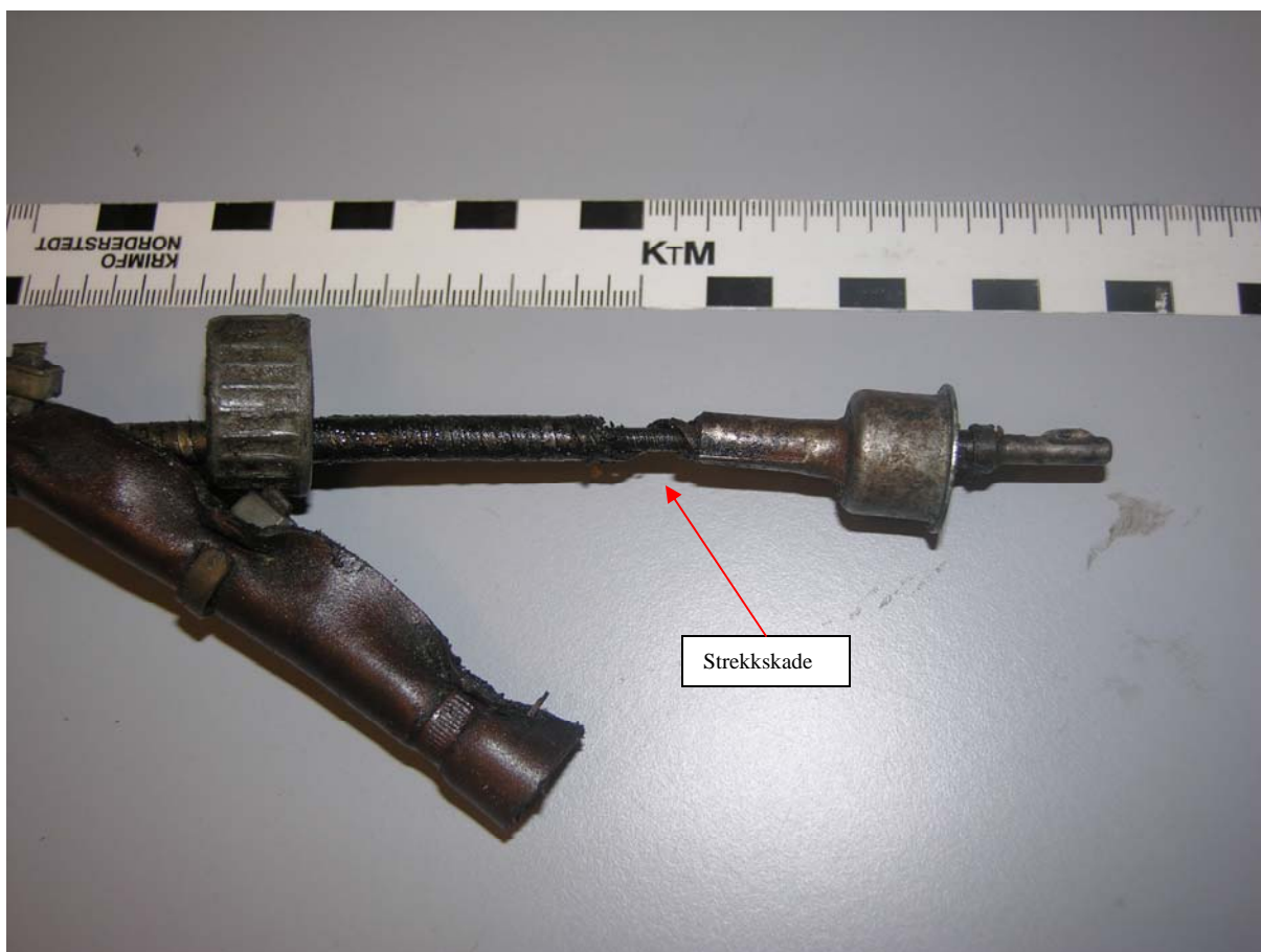
Fig. 6. skade på overføringskabel mellom motor og turteller.
