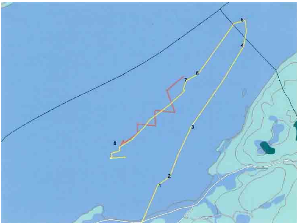
Fig. 2. Siste del av flygingen registrert på radar. Luftforsvaret rød strek, AVINOR gul strek. Mellom punkt 1 og 2: 8-tallsmanøver. Mellom punkt 2 og 4: Varierer høyden mellom 1 900 ft og 2 100 ft, og farten varierer mellom 60 og 90 kt. 5: Rutens nordligste punkt. 6: 2 100 ft og 60 kt. 7: 2 100 ft og 40 kt. 8: flyet forsvinner fra radar. Tider: Punkt 1, kl. 1117. Punkt 5, kl. 1121. Punkt 8, kl. 1125.
