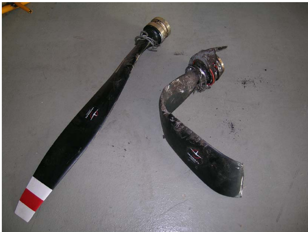
5. Forskjell i skader på propellbladene
