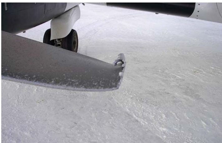
Fig. 5. Viser skade på tippen av høyre motors propell.
