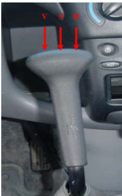
Fig. 8: Håndbetjent gass/brems med funksjonsbrytere
