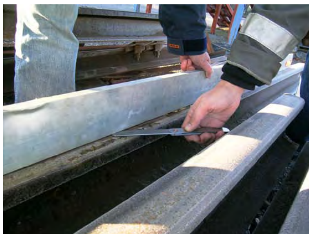
Figur 4: Måling av nedsenkning på kjørebanelen ved hjelp av linjal og bladsøker.
