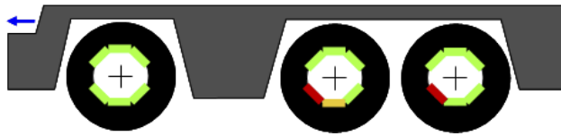
Figur 13: Slitasje på bremsebelegg, venstre side.
