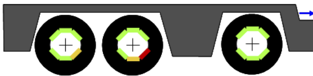
Figur 12: Slitasje på bremsebelegg, høyre side.
