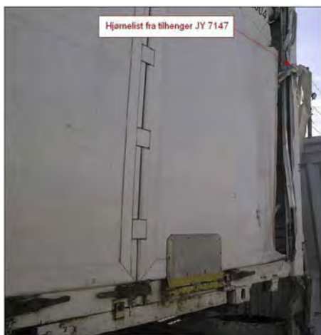
Figur 3: Bildet viser skader på lastebilens bakre venstre hjørne.
