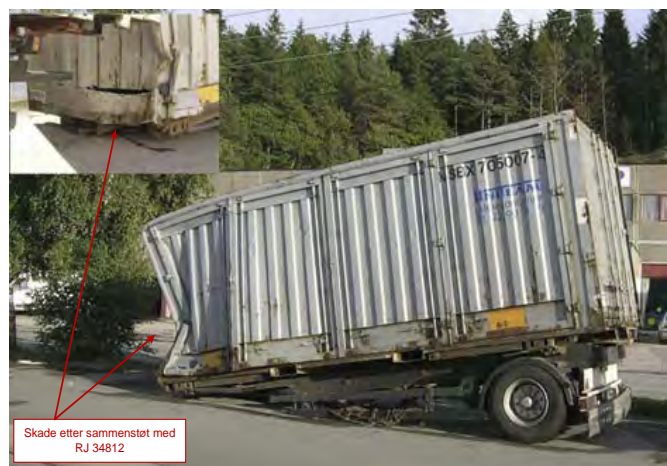
Figur 4: Bildet viser skade på tilhengeren. Innfelt bilde viser tilhengeren forfra.
