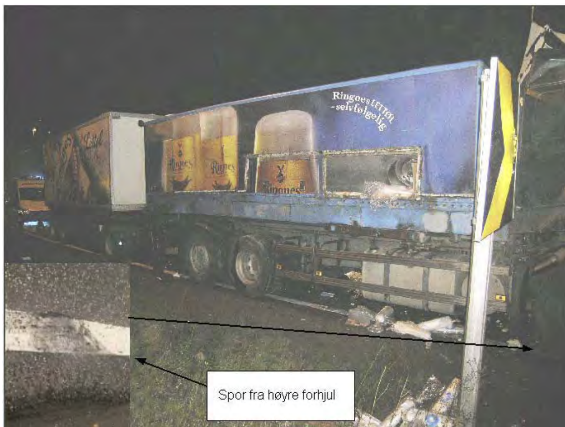
Figur 8: Bildet viser plasseringen av TS Transport AS sitt vogntog etter ulykken. Innfelt bilde viser spor fra lastebilens høyre forhjul på ulykkestidspunktet.
