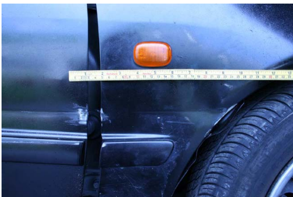
Figur 13: Merker fra autovern på Toyotas høyre side. (Foto: Statens vegvesen)
