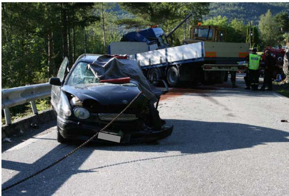
Figur 2: I forbindelse med redningsarbeidet ble Toyotaen dratt frem 1,7 m fra sin opprinnelige sluttposisjon i autovernet. Vogntogets sluttposisjon i bakgrunn. (Foto Statens vegvesen)
