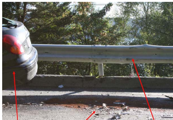
Figur 10: Mesteparten av nedfallet fra Toyota. Nedfall av glass fra hovedlykt litt lenger fram. Avtrykk etter dekk/hjul fra Toyota på autovernet. (Foto: Statens vegvesen)
