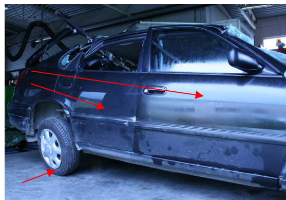
Figur 12: Skrapemerker langs hele høyre side med utmålt høyde fra bakken på 54 og 75 cm. Skade i høyre bakhjul etter sammentreff med autovern. (Foto: Statens vegvesen)
