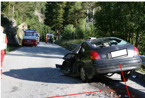
Figur 9: Viser at oljespor fortsatte ned mot lastebilens sluttposisjon. Ingen lekkasje påvist fra Toyota og ingen skader bak på Toyota. (Foto: Statens vegvesen)
