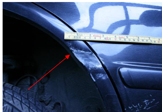
Figur 14: Avskraping av lakk legger seg i bakkant av oppskraping, tyder på bevegelse forover. (Foto: Statens vegvesen)
