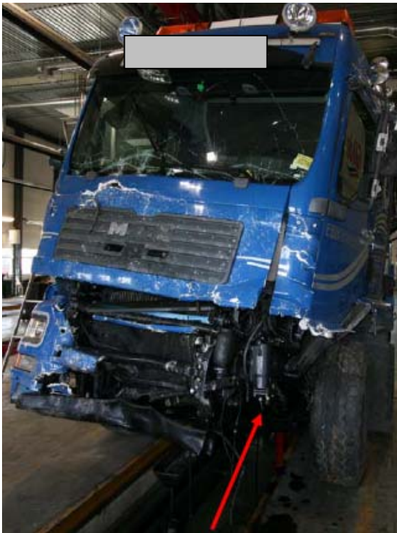
Figur 5: Skader på lastebil. Styresnekkens plassering antas å ha bidratt til oljelekkasje etter sammenstøt med Toyota. Styresnekken lå innenfor de 40 cm som lastebil har truffet inn på Toyota. (Foto: Statens vegvesen)
