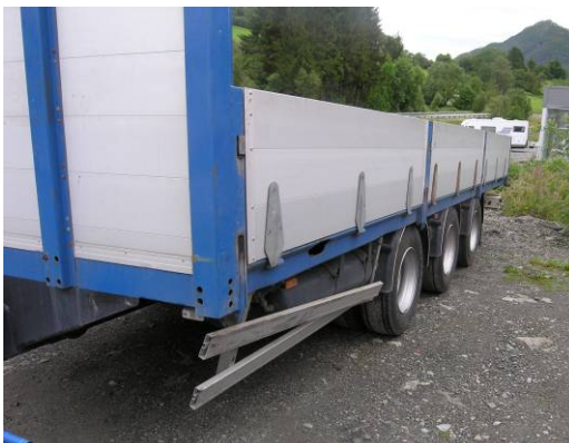
Figur 7: Skade på hengerens sidehinder foran på venstre side. (Foto Statens vegvesen)
