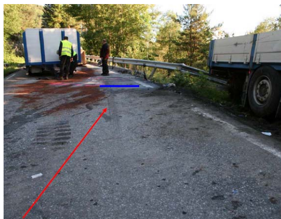
Figur 18: Tydelige 24,3 m bremsespor fra Caravelle. Sporene slutter ved blå strek som påviser kollisjonspunkt med lastebil. Bremsesporene bøydde av og fulgte autovernet de siste 2 m, noe som tyder på et sammenstøt med rekkverket like før kollisjonen med lastebilen. (Foto: Statens vegvesen)
