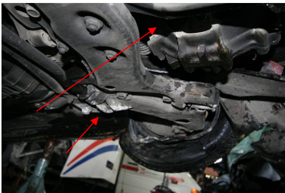
Figur 15: Ingen lekkasjer av olje fra Toyota. Karosserideler som har laget avsetning i asfalt der hvor lastebil har forlatt Toyota. Avstand fra denne og bak til bakhjul er 227 cm, og stemmer med spor på stedet. (Foto: Statens vegvesen).
