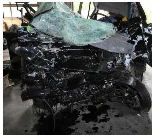
Figur 4: Store deformasjons- og knusningsskader på Volkswagen Caravelle. (Foto Statens vegvesen)
